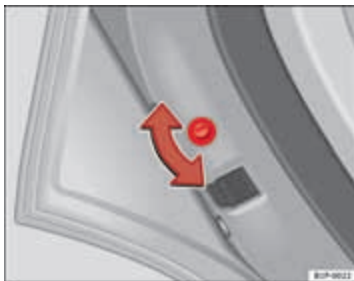
Afbeelding 59 Kinderslot in het linkerportier
