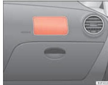
Afbeelding 18 Inbouwplaats bijrijdersairbag: in het dashboard
