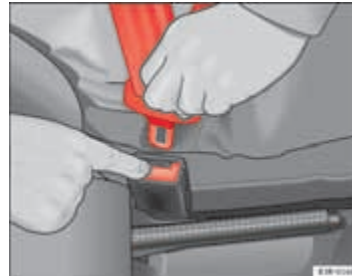
Afbeelding 15 Slotgesp uit het gordelslot losmaken
