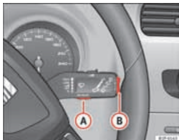
Afbeelding 45 Ruitenwischerhendel (MFA): toets A voor het bedienen van de keuzemogelijkheden en tuimelschakelaar B om van menu te wisselen
