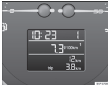
Afbeelding 42 Display in het instrumentenpaneel: weergave gemiddeld brandstofverbruik.
