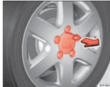
Afbeelding 154 Wiel verwisselen: Wieldop verwijderen
