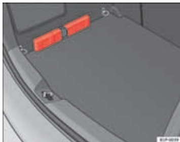
Afbeelding 103 Behuizing voor de gevarendriehoek in de bagageruimte
