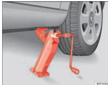
Afbeelding 157 Plaatsen van de krik
