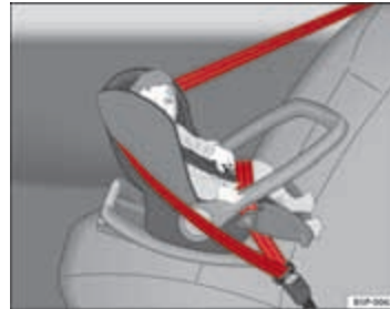
Afbeelding 27 Kinderzitje voor groep 0 op de achterbank waarbij het kind met de rug naar het dashboard is gekeerd.
