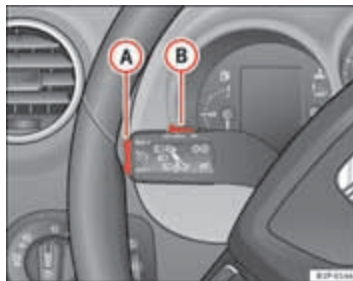
Afbeelding 132 Knipperlicht- en grootlichthendel: schakelaar en tuimelschakelaar voor het snelheidsregelsysteem
