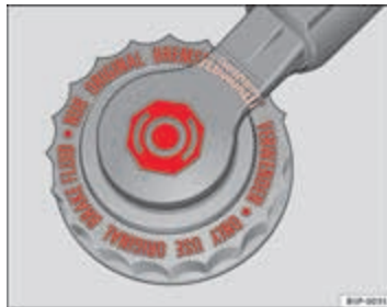
Afbeelding 150 In de motorruimte: vuldop van het remvloeistofreservoir
