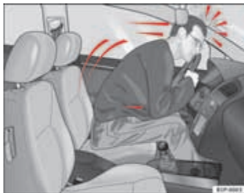
Afbeelding 8 De niet-vestigespte bestuurder vliegt naar voren
