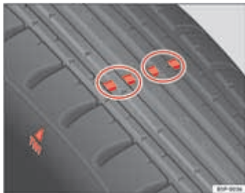
Afbeelding 151 Slijtagemerkttekens van het bandenprofiel
