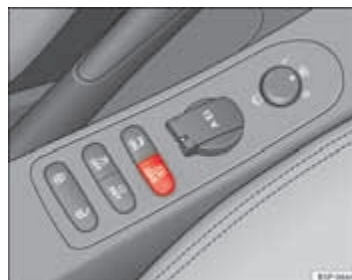
Afbeelding 117 Middenconsole: schakelaar van de gasinstallatie.
