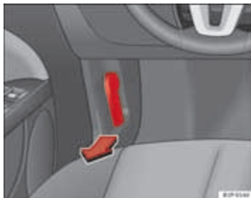
Afbeelding 141 Deel van de voetenruimte aan bestuurderszijde: ontgrendelingshendel voor de motorkap.
