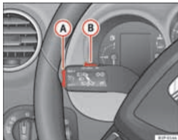
Afbeelding 133 Knipperlicht- en grootlichthendel: schakelaar en tuimelschakelaar voor het snelheidsregelsysteem
