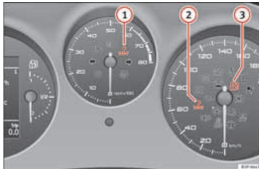
Afbeelding 49 Instrumentenpaneel met waarschuwings- en controlelampjes (wagens met LPG-systeem).
