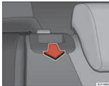
Afbeelding 92 Rugleuning van de stoel neerklappen
