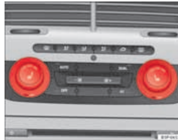
Afbeelding 91 Verwarming voorstoelen met Climatronic
