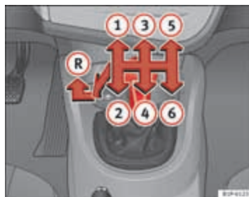
Afbeelding 121 Deel van de middenconsole: schakelschema van een 6-versnellings versnellingsbak
