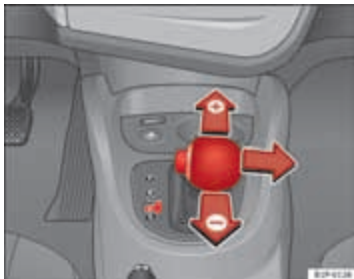
Afbeelding 126 Schakelen met tiptronic
