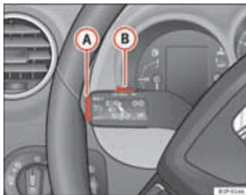
Afbeelding 131 Knipperlicht- en grootlichthendel: schakelaar en tuimelschakelaar voor het snelheidsregelsysteem
