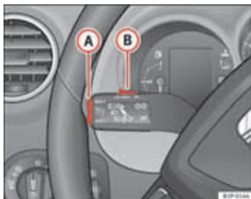
Abbeelding 134 Knipperlicht- en grootlichthendel: schakelaar en tuimelschakelaar voor het snelheidsregelsysteem
