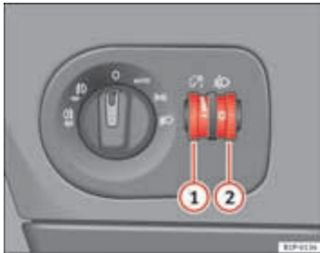
Afbeelding 72 Dashboard: regelaars voor instrumenten- en schakelaarverlichting en lichtbundel-hoogteverstelling
