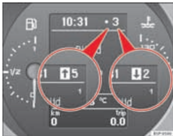
Afbeelding 38 Indicatie van de versnellingen
