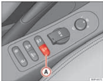
Afbeelding 118 Detail van de drukknop van de Start-Stop functie.
