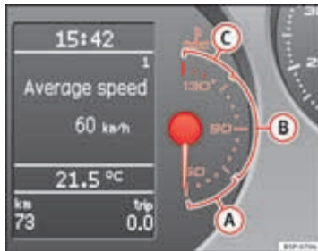
Afbeelding 34 Instrumentenpaneel: koelvloeistof temperatuurmeter
