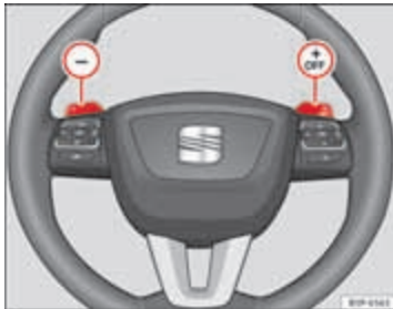
Afbeelding 127 Stuurwiel met hendels voor automatisch schakelen
