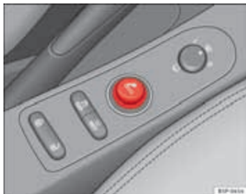
Afbeelding 98 De sigarettenaansteker zit in het stopcontact in de middenconsole voorin.
