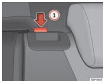
Afbeelding 93 Rugleuning van achterbank omhoogklappen
