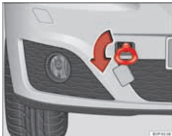
Afbeelding 181 Rechter- voorkant: vastschroeven van het sleepoog
