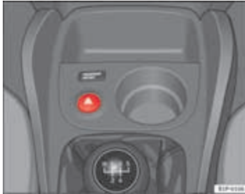
Abbeelding 74 Dash-board: schakelaar voor alarmlichten
