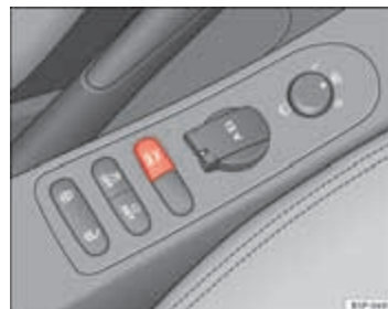
Afbeelding 129 Middenconsole: Schakelaar voor parkeerhulp
