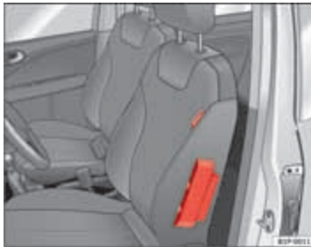
Afbeelding 21 Zijairbag in de bestuurdersstoel
