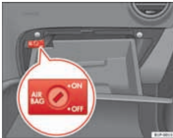
Afbeelding 25 In het dashboardkastje: sleutelschakelaar voor het in- en uitschakelen van de bijrijdersairbag
