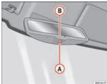
Afbeelding 84 Automatisch dimmende binnenspiegel.
