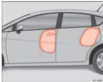
Afbeelding 22 Volledig geactiveerde zijairbag aan de linkerwagenzijde
