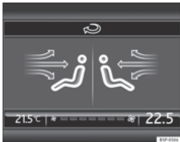
Afbeelding 110 Scherm van het navigatiesysteem met informatie van de Climatronic
