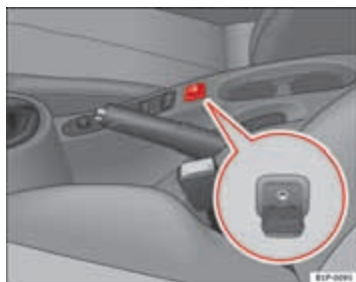
Afbeelding 100 Steker voor de extra audio-ingang
