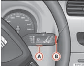
Afbeelding 43 Ruitenwisserhendel: toets A voor het bedienen van de keuzemogelijkheden en tuimelschakelaar B om van menu te wisselen
