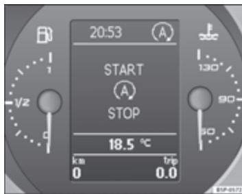
Afbeelding 119 Weergave op het display van het instrumentenpaneel tijdens de Start-Stop werking.
