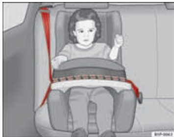
Afbeelding 28 In rijrichting geplaatst kinderzitje voor groep 1 op de achterbank.
