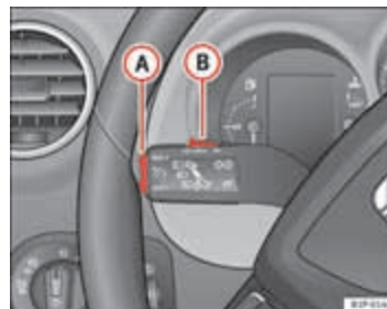
Afbeelding 130 Knipperlicht- en grootlichthendel: schakelaar en tuimelschakelaar voor het snelheidsregelsysteem
