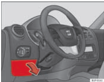
Afbeelding 159 Links in het dashboard: afdekking van de zekeringenhouder
