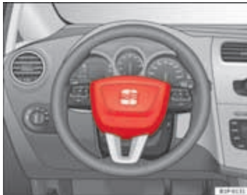
Afbeelding 17 Inbouwplaats bestuurdersairbag: in het stuurwiel
