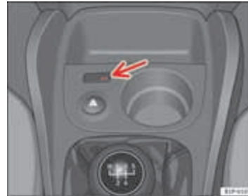
Afbeelding 26 Controlelampje voor buiten werking gestelde bijrijdersairbag
