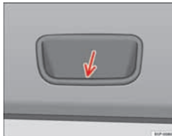
Afbeelding 65 Deel van de binnenbekleding van de achterklep: uitsparing voor dichttrekken
