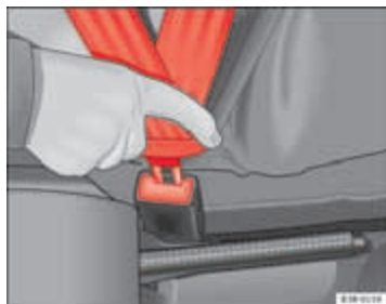
Afbeelding 11 Gordelslot en slotgesp van de veiligheidsgordel
