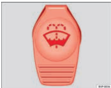
Abbeelding 146 In de motorruimte: vuldop van het vloeistofreservoir ruitensproeier
