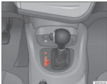
Afbeelding 122 Middenconsole: keuzehandel van automatische versnellingsbak / automatische versnellingsbak DSG
