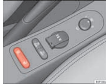
Afbeelding 57 Deel van de middenconsole: drukknop voor centrale vergrendeling
