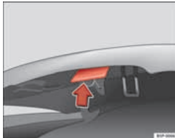
Afbeelding 142 Grendel voor het openen van de motorkap.
