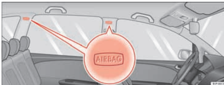
Afbeelding 23 Inbouwplaats van de hoofdairbags aan de linkerwagzijde
