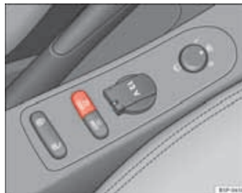
Afbeelding 115 Deel van de middenconsole: ESC-toets.
