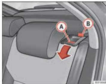
Afbeelding 90 Ontgrendelingshendel van de rugleuning
