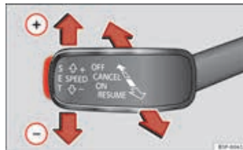
Afbeelding 128 Links van de stuurkolom: derde keuzehendel met 6 standen voor bediening van de GRA.
