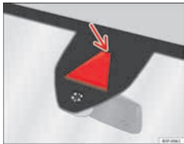
Afbeelding 143 Op de voorruit: Zichtveld van de camera van de rijstrookassistent
