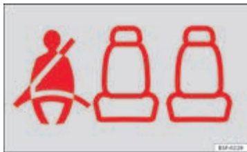
Afbeelding 7 Gordelstatusindicatie voor de zitplaatsen achterin, op het instrumentenpaneel.
