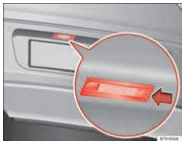
Afbeelding 198 In de achterbumper: kentekenverlichting
