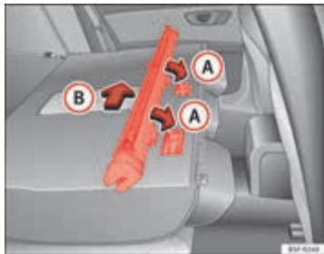
Afbeelding 100 Scheidingsnet op de rugleuningen van de achterbank inbouwen.
