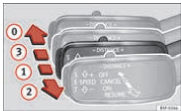
Afbeelding 132 Links van de stuurkolom: Derde hendel om de automatische afstandsregeling te bedienen.
