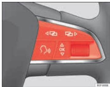
Afbeelding 43 Rechterdeel van het multifunctiestuurwiel: toetsen om de menu's van het instrumentenpaneel te gebruiken.
