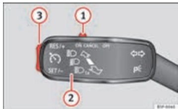
Afbeelding 127 Links van de stuurkolom: bedieningsschakelaar en -elementen van de GRA.
