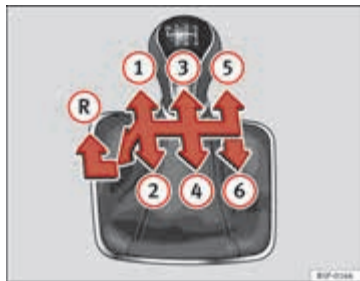
Afbeelding 121 Schema van een handmatige versnelling met 5 of 6 standen.
