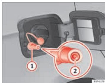
Afbeelding 152 Tankklep open: gasvulmond ①, plug van vulmond ②.
