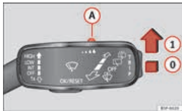
Afbeelding 72 Ruitenwischerhendel: regensensor (A) afstellen.
