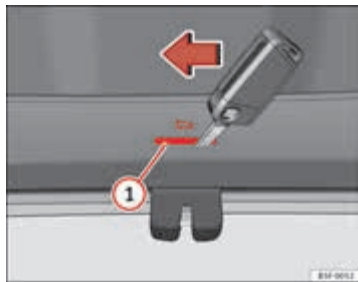
Afbeelding 58 Bagageruimte rechtsachter: toegang tot de noodontgrendeling
