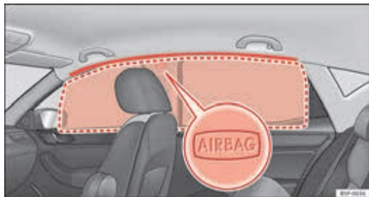
Afbeelding 27 Plaats van de hooflairbags
