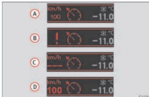
Abbeelding 126 Display in het instrumentenpaneel: statusaanwijzingen van GRA. ▶
