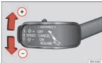
Afbeelding 133 Links van de stuurkolom: Derde hendel om de automatische afstandsregeling te bedienen.
