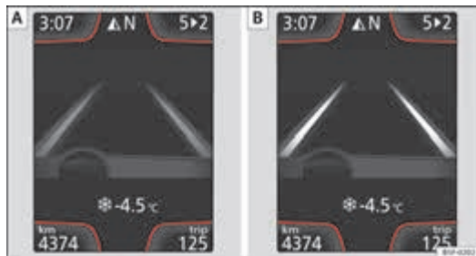
Afbeelding 141 Op het display van het instrumentenpaneel: Indicatie op het display van de rijstrookassistent (voorbeeld 1)
