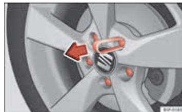
Afbeelding 166 Wiel: wielbouten met doppen
