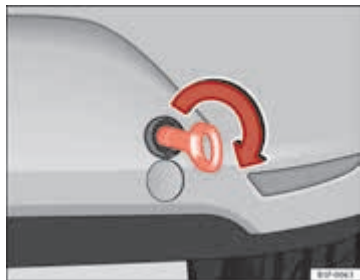
Afbeelding 135 Achterbumper rechts: Vastgeschroefd sleepoog
