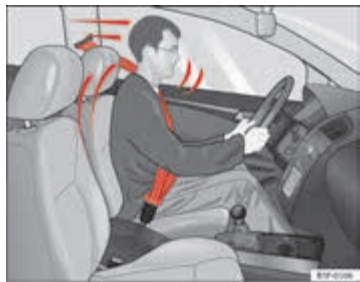
Afbeelding 12 Bestuurder met de veiligheidsgordel goed om: wordt bij plotseling remmen door de gordel tegengehouden
