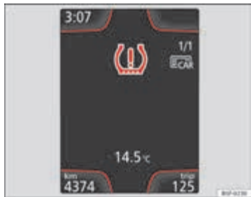
Afbeelding 106 Instrumentenpaneel: waarschuwing bandenspanningsverlies
