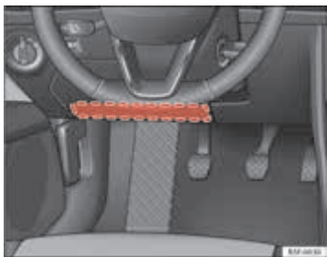
Afbeelding 23 Aan de bestuurderszijde: plaats van de airbag voor de knieën.
