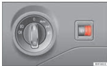
Afbeelding 64 Naast het stuur: lichtbundelhoogteverstelling.
