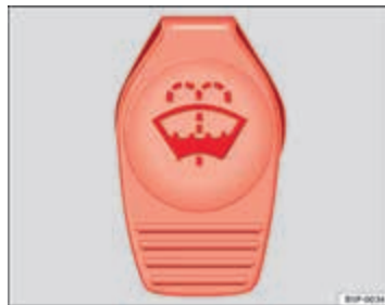
Afbeelding 70 In de motorruimte: dop van het ruitensproeiervloeistofreservoir.
