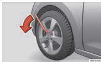
Afbeelding 127 Wiel: de wielbouten losdraaien
