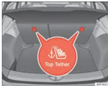
Afbeelding 35 Stand van de Top Tether-ringen aan de achterzijde van de achterbank
