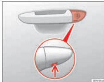
Afbeelding 54 Portiergreep aan bestuurderszijde: verborgen portierslotcilinder.
