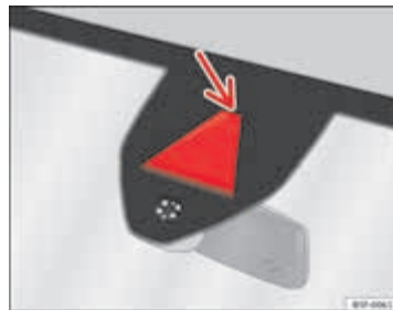
Afbeelding 103 Op de voorruit: Zichtveld van de camera van de rijstrookassistent
