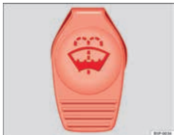
Afbeelding 117 Motorcompartment: Dop van het ruitensproeiervloeistofreservoir
