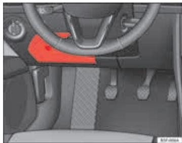
Afbeelding 136 In het dashboard aan bestuurderszijde: deksel van de zekeringenhouder.
