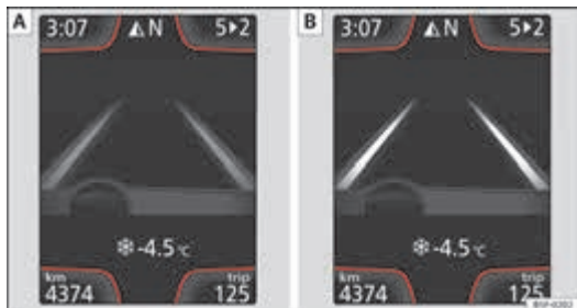
Afbeelding 101 Op het display van het instrumentenpaneel: Indicatie op het display van de rijstrookassistent (voorbeeld 1)
