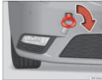
Afbeelding 133 Voorbumper rechts: Vastgeschroefd sleepoog
