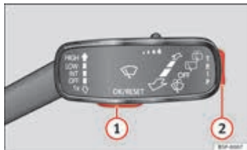
Afbeelding 42 In wagens zonder multifunctiestuurwiel: Toets ① in de ruitenwisserhendel voor het bevestigen van de opties in het menu en tuimelaarschakelaar ② voor het wisselen van menu.
