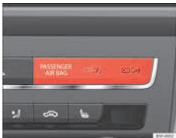
Afbeelding 29 Controlelampje van het buitenwerkingsstellen van de bijrijdersairbag
