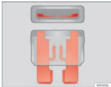
Afbeelding 138 Voorbeeld van een doorgebrande zekering.
