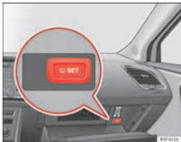
Afbeelding 107 Dashboardkastje: schakelaar voor het bandenspanningscontrolesysteem
