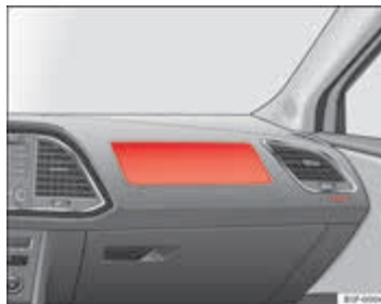
Afbeelding 20 Inbouw-plaats bijrijdersairbag: in het dashboard
