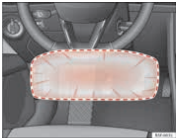
Afbeelding 24 Aan de bestuurderszijde: Werkingsgebied van de airbag voor de knieën.
