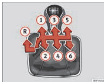
Afbeelding 93 Schema van een handmatige versnelling met 5 of 6 standen.
