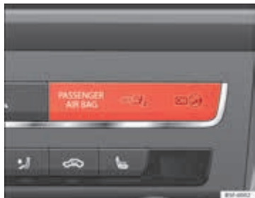
Afbeelding 18 Controlelampje in het dashboard voor de uitschakeling van de voorairbag van de voorpassagier.
