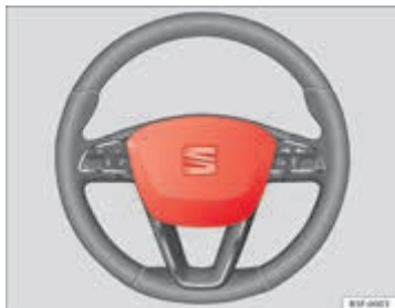
Afbeelding 19 Inbouw-plaats bestuurdersairbag: in het stuurwiel
