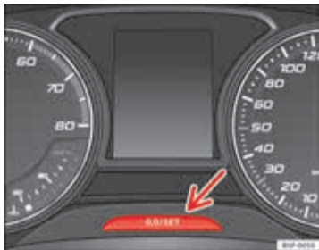
Afbeelding 40 Instrumentenpaneel: Kilometerteller en resetknop
