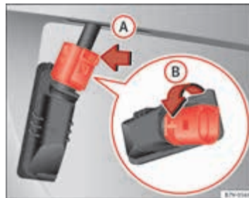
Afbeelding 158 kentekenverlichting: fitting uitbouwen
