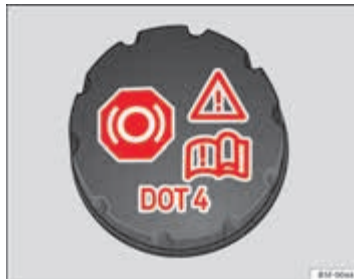
Afbeelding 116 Motorcompartiment: dop van het remvloeistofreservoir
