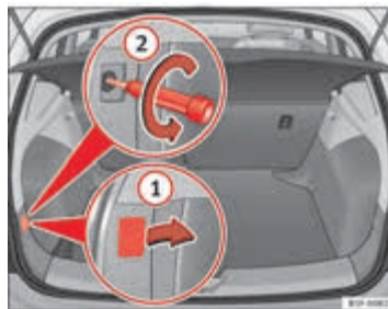
Abbeelding 151 Bagage-ruimte: Inbouwstand van de bevestigingsbout van het achterlicht
