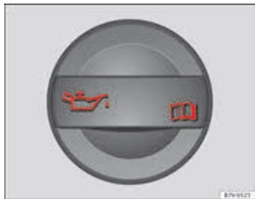
Afbeelding 114 In de motorruimte: dop van de motorolie-vulopening
