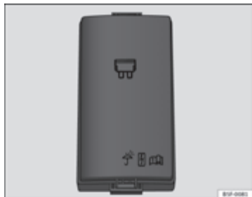
Afbeelding 137 In de motorruimte: deksel van de zekeringenhouder.
