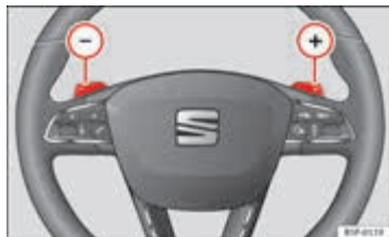
Afbeelding 96 Stuurwiel: hendels voor handmatig schakelen bij een automatische transmissie
