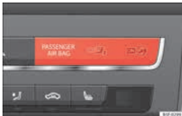
Afbeelding 75 Controlelampje voor het buiten werking stellen van de bijrijdersairbag.
