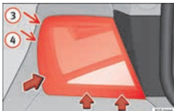
Afbeelding 218 Uitbouwen van achterlicht in zijpaneel.
