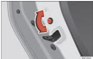
Afbeelding 95 Kinderslot in het linkerportier.
