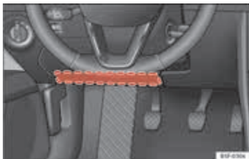
Afbeelding 68 Aan de bestuurderszijde: plaats van de airbag voor de knieën.
