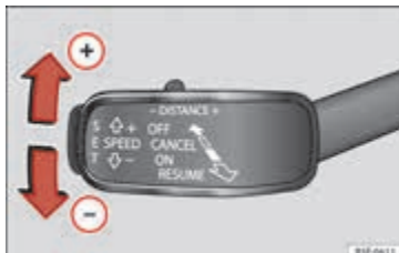
Afbeelding 153 Links van de stuurkolom: derde hendel om de automatische afstandsregeling te bedienen.
