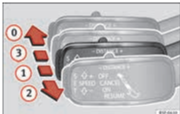
Afbeelding 152 Links van de stuurkolom: derde hendel om de automatische afstandsregeling te bedienen.
