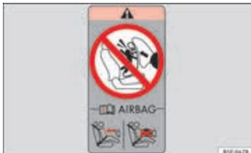
Afbeelding 77 In de achterste omlijsting van het bestuurdersportier: sticker over de airbag.
