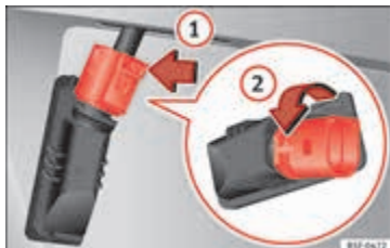
Afbeelding 224 kentekenverlichting: fitting uitbouwen.
