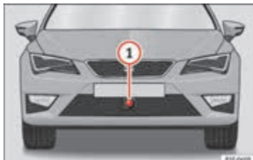
Afbeelding 151 Op de voorbumper: radarsensor.
