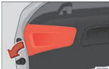
Afbeelding 220 Afdekking in de achterklep verwijderen.
