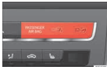
Afbeelding 73 Controlelampje in het dashboard voor de uitschakeling van de voorairbag van de voorpassagier. »
