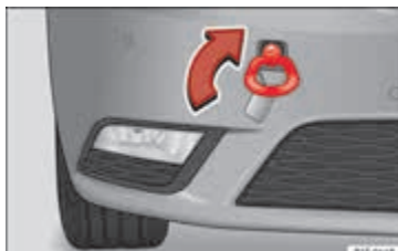
Afbeelding 191 Voorbumper rechts: vastgeschroefd sleeppoog.
