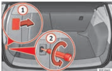
Afbeelding 217 Bagageruimte: inbouwstand van de bevestigingsbout van het achterlicht.
