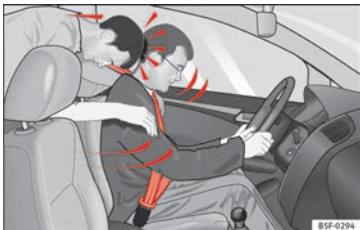
Afb. 90 De niet-vestigespte passagier op een zitplaats achterin vliegt naar voren op de vastgesespte bestuurder.
