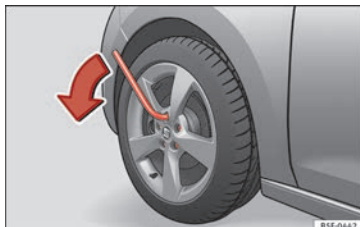
Afb. 72 Wiel: de wielbouten losdraaien.
