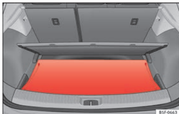
Afb. 164 In de bagageruimte: plaatsen van de hoedenplank.
