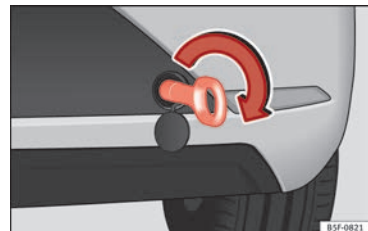
Afb. 76 Achterbumper rechts: vastgeschroefd sleepoog.
