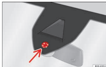
Afb. 144 Gevoelig oppervlak van de regensensor.
