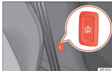
Afb. 135 Toets voor interieurbewaking/afsleepalarm.
