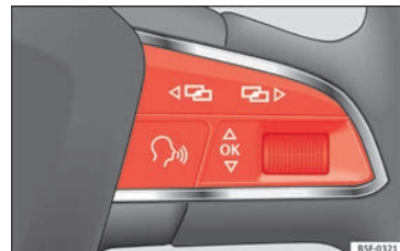
Afb. 43 Rechterdeel van het multifunctiestuurwiel: controlettoetsen.
