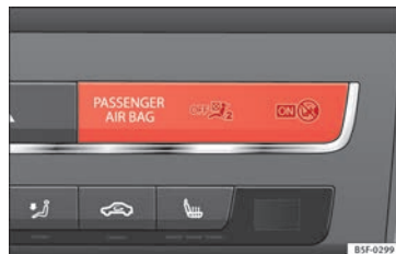
Afb. 51 Controlelampje voor het buiten werkingsstellen van de bijrijdersairbag.
