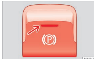
Afb. 188 Onder in de middenconsole: toets van de elektronische parkeerrem.
