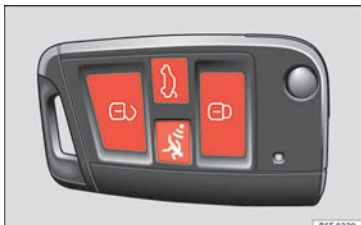
Afb. 1 Sleutel met afstandsbediening: toetsen.
