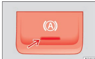
Afb. 195 Onder in de middenconsole: toets van de Auto Hold-functie.
