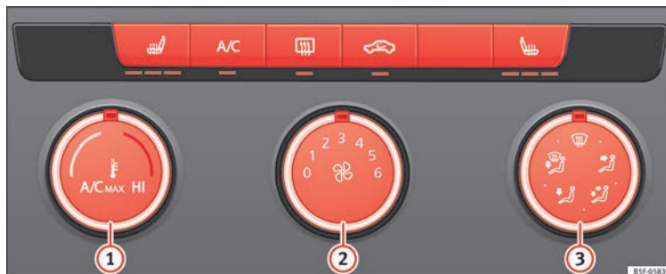
Afb. 56 In de middenconsole: knoppen voor de handbediende airconditioning.
