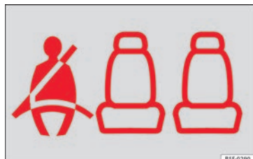
Afb. 87 Instrumentenpaneel: geeft aan dat de plaats rechtsachter bezet is en de overeenkomstige veiligheidsgordel juist is omgedaan.
