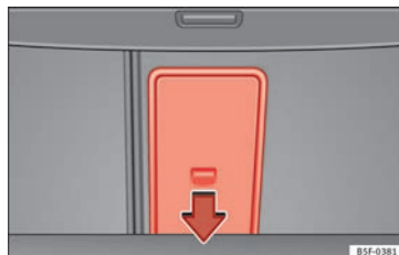
Afb. 172 In de bagageruimte: openen van het luik.
