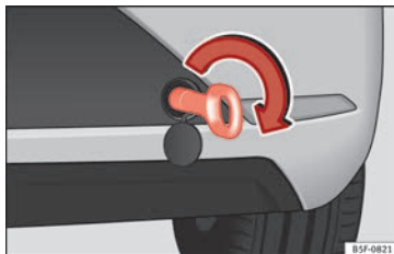
Afb. 99 Achterbumper rechts: vastgeschroefd sleepoog.
