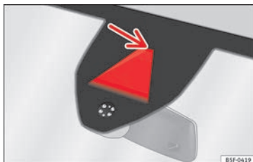
Afb. 214 Op de voorruit: gezichtsveld van de rijstrookassistent.
