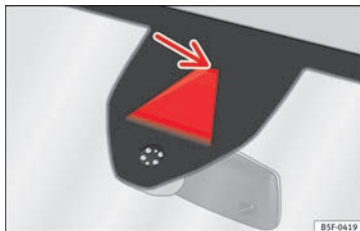
Afb. 216 Op de voorruit: gezichtsveld van de rijstrookassistent.
