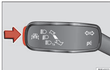
Afb. 45 In de knipperlicht- en grootlichthendel: toets voor de systemen ter ondersteuning van de bestuurder.
