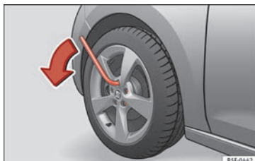
Afb. 74 Wiel: de wielbouten losdraaien.
