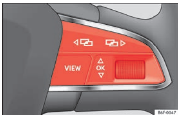
Afb. 44 Rechterdeel van het multifunctiestuurwiel: controlettoetsen.
