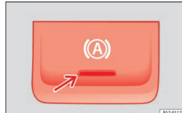
Afb. 202 Onder in de middenconsole: toets van de Auto Hold-functie.
