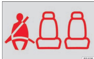
Afb. 89 Instrumentenpaneel: geeft aan dat de plaats rechtsachter bezet is en de overeenkomstige veiligheidsgordel juist is omgedaan.
