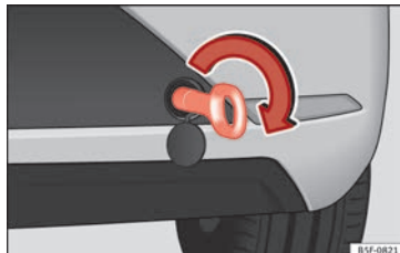
Afb. 100 Achterbumper rechts: vastgeschroefd sleepoog.
