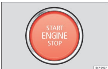
Afb. 192 Onder in de middenconsole: startknop.
