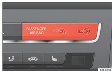
Afb. 96 Dashboard: controlelampje voor buiten werking gestelde bijrijdersairbag.
