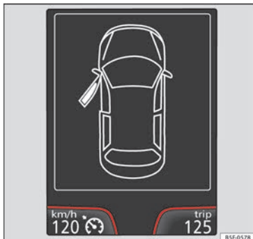
Afb. 52 Op het display van het instrumentenpaneel: weergave portieren open.
