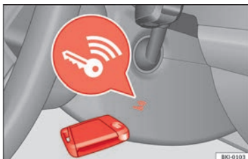
Afb. 193 Rechts van de stuurkolom: noodstart.
