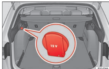
Afb. 162 Deel van de zijbekleding van de bagageruimte: stopcontact van 12 volt (enkel geldig voor het model LEON ST).
