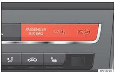
Afb. 23 Dashboard: controlelampje voor buiten werking gestelde bijrijdersairbag.
