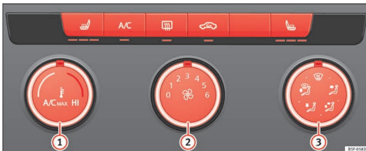
Afb. 58 In de middenconsole: knoppen voor de handbediende airconditioning.
