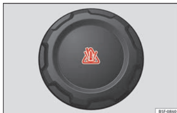
Afb. 63 Motorruimte: vuldop van het koelvloeistofexpansiereservoir.
