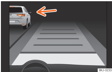
Afb. 274 Op het display van het instrumentenpaneel: ACC actief, voertuig herkend aan de linkerzijde
