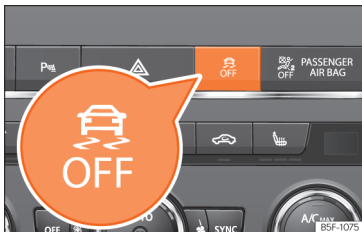
Afb. 288 Middenconsole: Toets om ESC en ASR in/uit te schakelen
