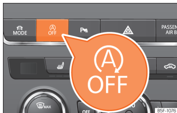
Afb. 257 Middenconsole: toets van het start-stopsysteem.
