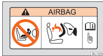
Afb. 26 Sticker van de airbag: op de zonneklep aan bestuurderszijde
