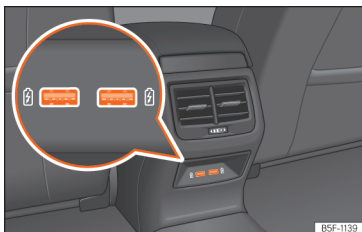
Afb. 251 Achterzijde middenconsole: USB-aansluitingen.
