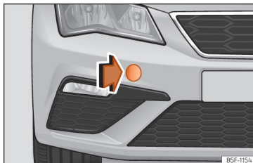
Afb. 47 Aan de rechterzijde van de voorbumper: de afdekking verwijderen.
