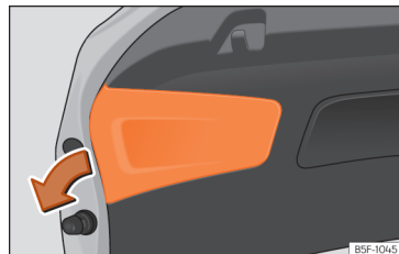
Afb. 67 Afdekking in de achterklep verwijderen
