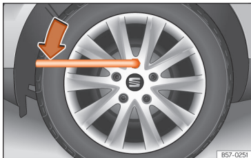
Afb. 38 Wiel verwisselen: wielbouten losdraaien.
