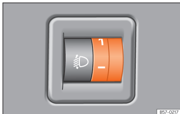
Afb. 118 Naast het stuur: lichtbundelhoogteverstelling
