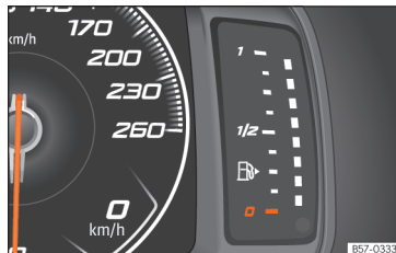
Afb. 80 Digitaal instrumentenpaneel: brandstofmeter.
