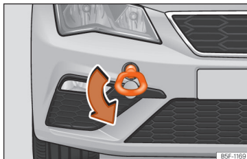
Afb. 48 Rechterzijde van de voorbumper: vastgeschroefd sleepoog.
