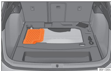
Afb. 229 Hybride wagens (PHEV): locatie van de accu in de bagageruimte
