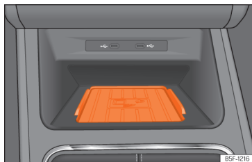
Afb. 172 In de middenconsole: steun voor het aansluiten van de mobiele telefoon.
