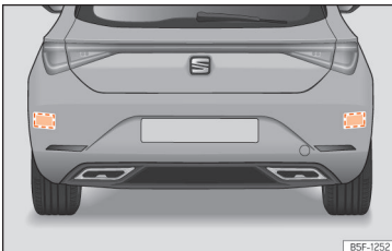
Afb. 125 Achteraanzicht van de wagen: zones van de radarsensoren.
