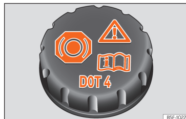
Afb. 223 Motorruimte: dop van het remvloeistofreservoir.
