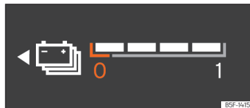
Afb. 9 Digitaal instrumentenpaneel: accupeilmeter.
