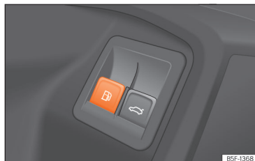
Afb. 202 Bestuurdersportier: ontgrendeling van de tankklep.
