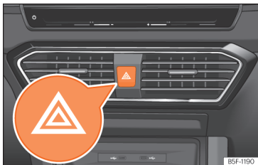
Afb. 52 Dashboard: schakelaar voor alarmlichten.
