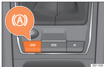
Afb. 147 Onder in de middenconsole: functietoets Auto Hold.
