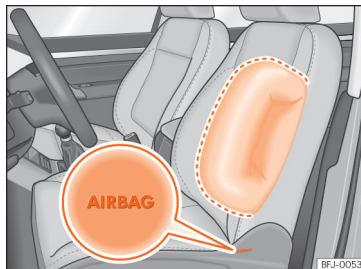
Afb. 36 Zij-airbag in de bestuurdersstoel.
