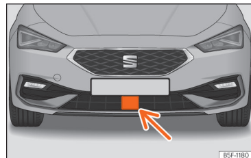
Afb. 122 In de voorbumper: radarsensor.
