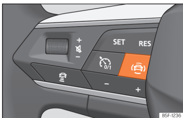
Afb. 121 Linkerzijde van het multifunctiestuurwiel: toets voor de bestuurdershulpsystemen (naargelang het model).
