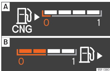
Afb. 8 Digitaal instrumentenpaneel: A : Aardgasmeter. B : Benzinemeter
