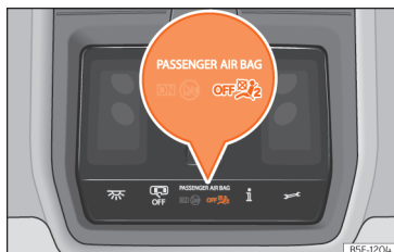
Afb. 33 In de dakconsole: controlelampje van uitschakeling bijrijdersairbag.
