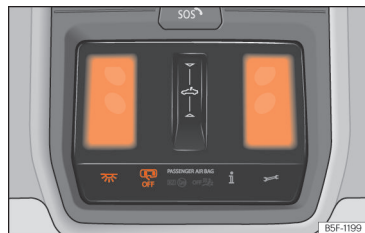
Afb. 103 Deel van de hemelbekleding: binnenverlichting voorin.
