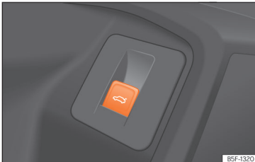
Afb. 80 In het bestuurdersportier: knop om de achterklep te openen en sluiten.
