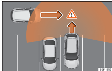
Afb. 156 Schematische voorstelling van de uitparkeerhulp: bewaakt gebied rond de wagen die een parkeerplaats verlaat
