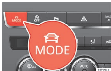
Fig. 215 Centre console: MODE button.
