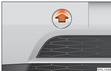
Afb. 42 Voorbumper rechts: de afdekking verwijderen.
