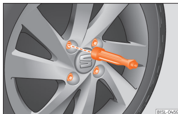
Afb. 37 Wiel verwisselen: de wielbouten met de schroevendraaiergreep losdraaien.
