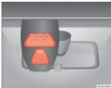
Afbeelding 96 Op de voorruit: Lasersensor voor de functie Remassistent in stadsverkeer
