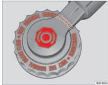
Abbeelding 91 In de motorruimte: dop van het remvloeistofreservoir
