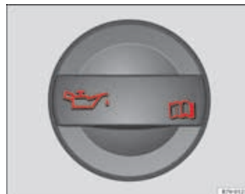
Afbeelding 112 In de motorruimte: dop van de motorolievulopening. ▶
