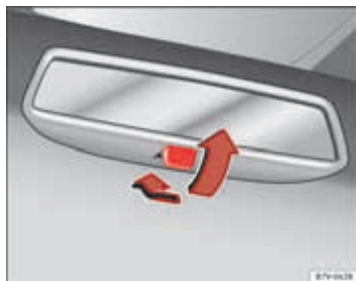
Afbeelding 64 Handmatig dimmende binnenspiegel.
