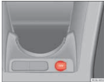
Afbeelding 82 Middenconsole voorin: 12 Volt-stopcontact in het opbergvak.
