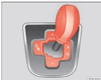
Afbeelding 87 Keuzehendel van de automatische transmissie.
