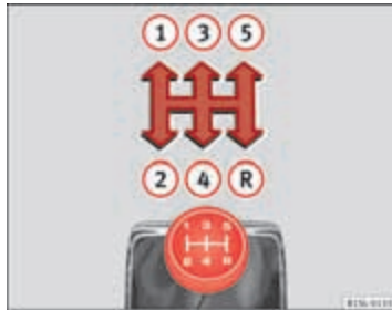
Afbeelding 86 Schakel- schema van handgeschakelde 5-versnellingsbak.
