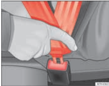
Afbeelding 42 Schuif de gesp van de veiligheidsgordel in het slot.
