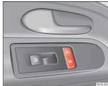
Afbeelding 19 In het bestuurdersportier: drukknop voor centrale vergrendeling.
