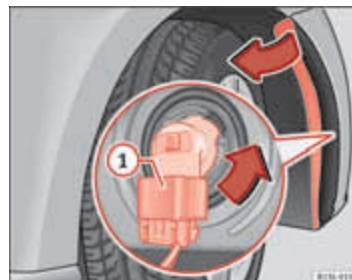
Afbeelding 152 Gloeilampen in de koplamp vervangen.
