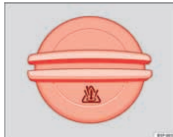
Afbeelding 114 In de motorruimte: vuldop van het koelvloeistofexpansiereservoir.
