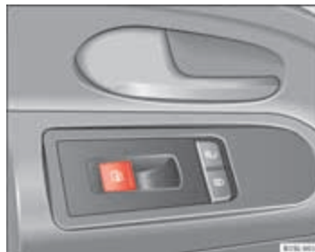
Afbeelding 24 In het bestuurdersportier: Knop voor ruitbediening.
