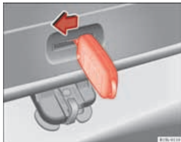
Afbeelding 135 Via de bagageruimte: noodontgrendeling van de achterklep.
