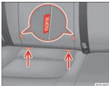
Afbeelding 53 Op de stoel van de wagen: identificatievarianten van de onderste verankeringen voor kinderzitjes.
