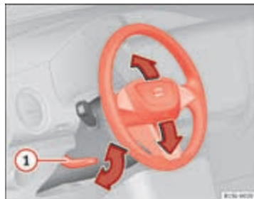
Afbeelding 33 Mechanisch verstellen van het stuurwiel.
