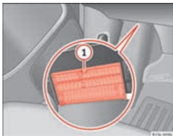
Afbeelding 147 Onder het dashboard aan bestuurderszijde: deksel van de zekeringenhouder.
