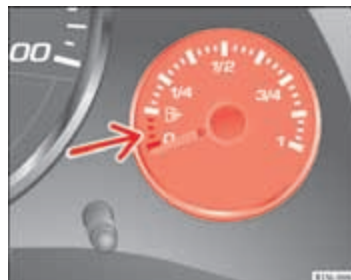
Afbeelding 105 In het instrumentenpaneel: brandstofmeter voor benzine.
