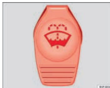
Afbeelding 63 In de motorruimte: dop van het ruitensproeiervloestofreservoir.
