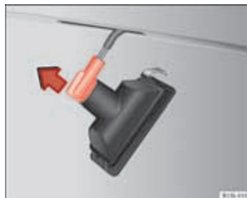
Afbeelding 156 Kentekenplaatverlichting: fitting uitbouwen.
