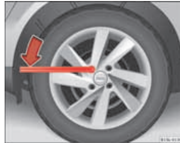
Afbeelding 141 Wiel verwisselen: de wielbouten losdraaien.
