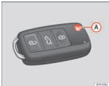
Afbeelding 12 Sleutel met radiografische afstandsbediening.
