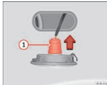
Afbeelding 158 Zijknipperlicht: lampen vervangen. ▶
