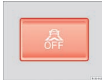
Afbeelding 98 Onder in de middenconsole: knop voor de functie Remassistent in stadsverkeer.
