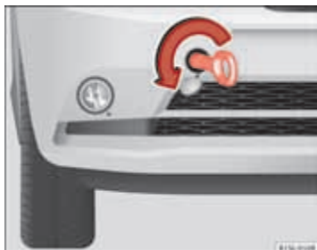
Afbeelding 162 Rechts op de voorbumper: schroef het sleepoog vast.
