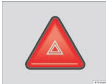
Afbeelding 130 Dashboard: Knop voor aan- en uitzetten van de alarmlichten.
