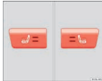
Afbeelding 34 In de middenconsole: Schakelaars voor stoelverwarming voor de voorstoelen.
