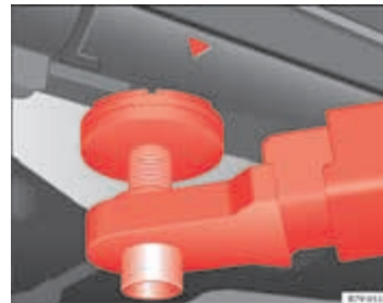
Afbeelding 128 Achterste steunpunten om de wagen met een hefbrug of krik omhoog te brengen.
