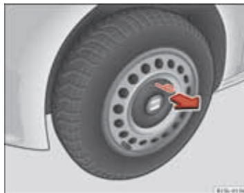
Afbeelding 138 Verwijder de wieldop van de stalen velg.
