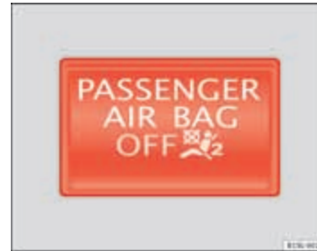
Afbeelding 46 Controlelampje in het dashboard voor de uitschakeling van de voorairbag van de voorpassagier.
