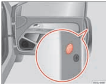
Afbeelding 133 Vooraan in het voorpassagiersportier: noodslot, verborgen door een rubberen pakking.
