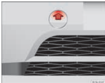
Afbeelding 161 Rechts op de voorbumper: het klepje verwijderen.
