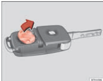
Afbeelding 16 Autosleutel: de batterij vervangen.
