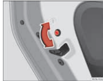
Afbeelding 21 Kinderslot in het linkerportier
