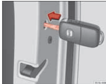
Afbeelding 134 Noodslot van de wagen met de autosleutel.
