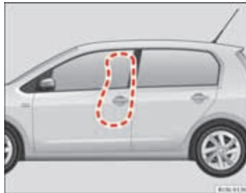
Afbeelding 51 Aan de linkerkant van de wagen: ontplooiingsgebied van de zijairbag.
