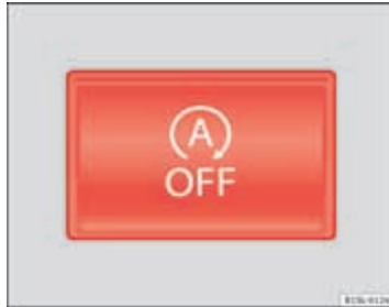
Afbeelding 101 Boven in de middenconsole: knop van het Start-Stopsysteem.
