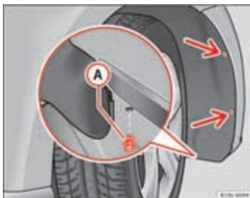
Afbeelding 151 Op het binnenscherm rechts-voor: Verwijder de bevestigingsschroef (pijlen) en verwijder de spreidklinknagel A .
