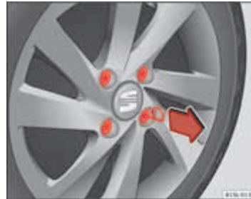
Afbeelding 140 Verwijder de doppen van de wielbouten.
