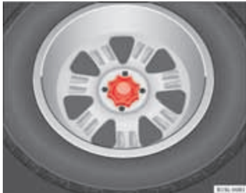
Afbeelding 123 In de bagageruimte: kartelwiel om het reservewiel vast te zetten.
