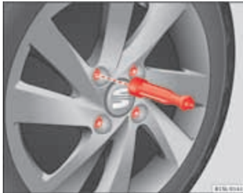
Afbeelding 145 Wiel verwisselen: de wielbouten met de schroevendraaiergreep losdraaien.
