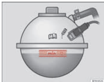
Afbeelding 113 In de motorruimte: markering aan het koelvloeistofexpansiereservoir.
