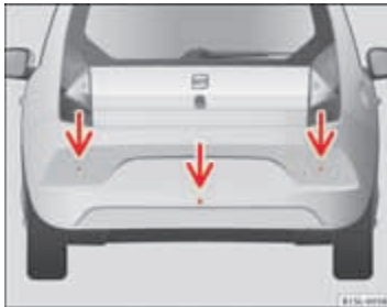
Afbeelding 93 Parkeerhulpsensoren in de achterbumper.
