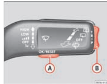
Afbeelding 11 Ruitenwisserhendel: knop (A) om indicatiepunten te bevestigen en tuimelschakelaar (B) om indicatiepunten te wijzigen.
