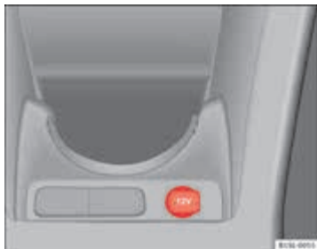
Afbeelding 85 Middenconsole voorin: 12 Volt-stopcontact in het opbergvak.
