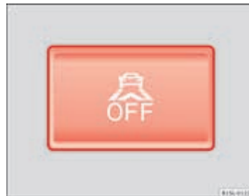
Afbeelding 101 Onder in de middenconsole: knop voor de functie Remassistent in stadsverkeer.
