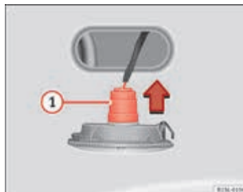
Afbeelding 161 Zijknipperlicht: lampen vervangen. ►
