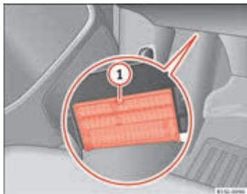
Afbeelding 150 Onder het dashboard aan bestuurderszijde: deksel van de zekeringenhouder.
