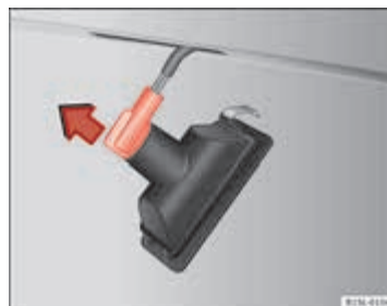
Afbeelding 159 Kentekenplaatverlichting: fitting uitbouwen. ▶
