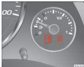
Afbeelding 109 In het instrumentenpaneel: brandstofmeter voor benzine en aardgas.
