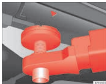
Afbeelding 131 Achterste steunpunten om de wagen met een hefbrug of krik omhoog te brengen.
