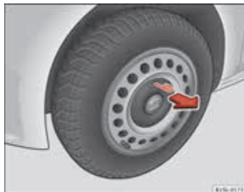
Afbeelding 141 Verwijder de wieldop van de stalen velg.
