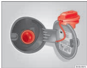
Afbeelding 110 Geopende tankklep met vastgehaakte tankdop.
