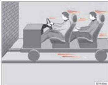
Afbeelding 37 Wagen staat op het punt tegen een muur te botsen: de inzittenden hebben de veiligheidsgordel niet om.
