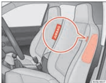
Afbeelding 50 Aan de zijkant van de voorstoel: plaats van de zijairbag.
