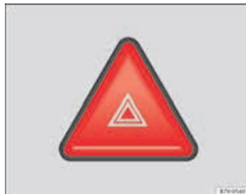
Afbeelding 133 Dashboard: Knop voor aan- en uitzetten van de alarmlichten.
