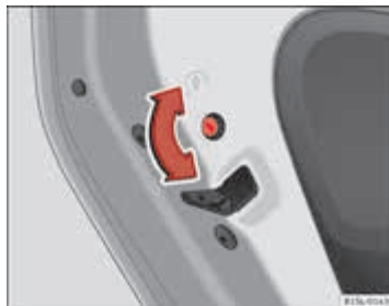
Afbeelding 21 Kinderslot in het linkerportier
