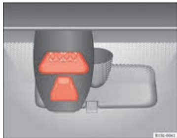
Afbeelding 99 Op de voorruit: Lasersensor voor de functie Remassistent in stadsverkeer
