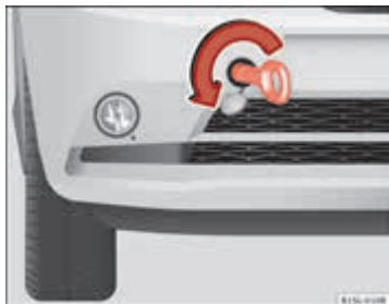
Afbeelding 165 Rechts op de voorbumper: schroef het sleepoog vast.
