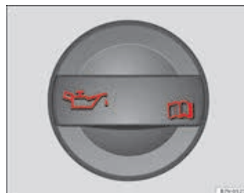
Afbeelding 115 In de motorruimte: dop van de motorolievulopening. ►
