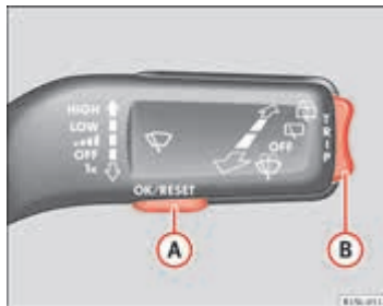
Afbeelding 11 Ruitenswisserhendel: knop (A) om indicatiepunten te bevestigen en tuimelschakelaar (B) om indicatiepunten te wijzigen.
