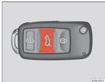
Afbeelding 22 Op de autosleutel: Knop om achterklep te ontgrendelen en te openen.
