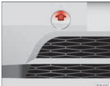
Afbeelding 164 Rechts op de voorbumper: het klepje verwijderen.
