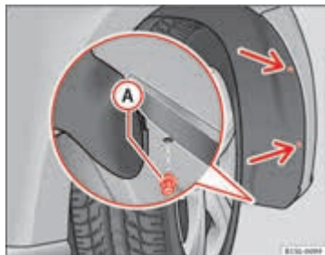
Afbeelding 154 Op het binnenscherm rechtsvoor: Verwijder de bevestigingsschroef (pijlen) en verwijder de spreidklinknagel (A).
