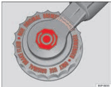
Afbeelding 94 In de motorruimte: dop van het remvloeistofreservoir
