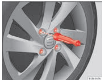
Afbeelding 148 Wiel verwisselen: de wielbouten met de schroevendraaiergreep losdraaien.
