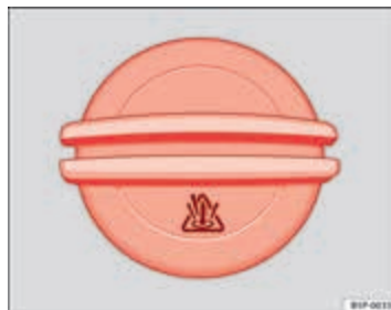
Afbeelding 117 In de motorruimte: vuldop van het koelvloeistofexpansiereservoir.
