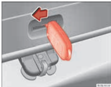
Afbeelding 138 Via de bagageruimte: noodontgrendeling van de achterklep.
