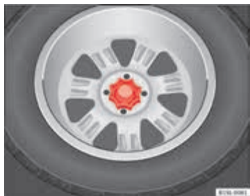
Afbeelding 126 In de bagageruimte: kartelwiel om het reservewiel vast te zetten.
