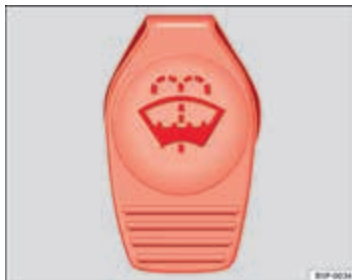
Afbeelding 63 In de motorruimte: dop van het ruitensproeiervloeistofreservoir.
