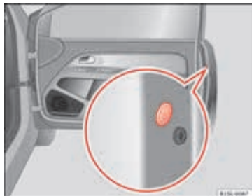
Afbeelding 136 Vooraan in het voorpassagiersportier: noodslot, verborgen door een rubberen pakking.
