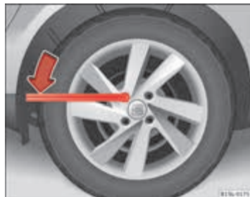
Afbeelding 144 Wiel verwisselen: de wielbouten losdraaien.
