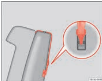
Afbeelding 54 Voorbeeld van een aangekoppelde bovenbevestigingsriem.
