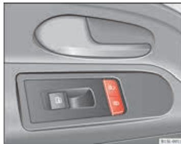
Afbeelding 19 In het bestuurdersportier: drukknop voor centrale vergrendeling.
