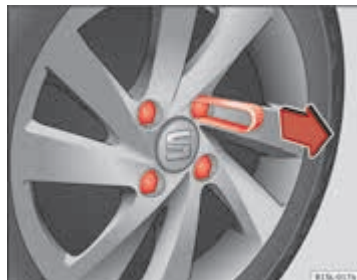
Afbeelding 143 Verwijder de doppen van de wielbouts.
