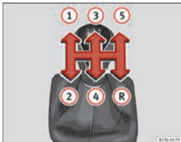
Afbeelding 89 Schakel-schema van handgeschakelde 5-versnellingsbak.
