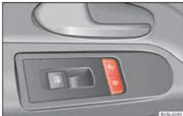
Afbeelding 34 In het bestuurdersportier: drukknop voor centrale vergrendeling.
