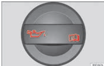
Afbeelding 108 In de motorruimte: dop van de motorolievulopening.
