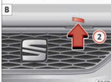
Afbeelding 105 A: Ontgrendelingshendel in de voetenruimte, aan bestuurderszijde. B: Ontgrendelingshendel van de motorkap.
