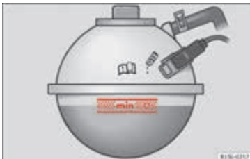
Afbeelding 109 In de motorruimte: markering aan het koelvloeistofexpansiereservoir.
