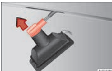
Afbeelding 152 Kentekenplaatverlichting: fitting uitbouwen.
