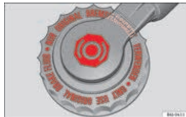
Afbeelding 111 In de motorruimte: dop van het remvloeistofreservoir
