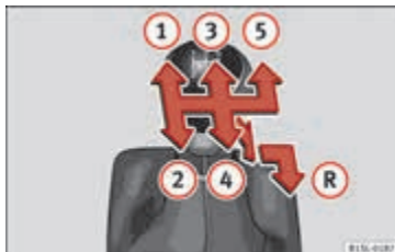
Afbeelding 81 Schakelschema van handgeschakelde 5-versnellingsbak.
