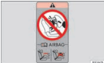
Afbeelding 19 In de achterste omlijsting van het bestuurdersportier: sticker over de airbag.
