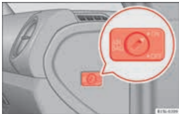
Afbeelding 17 Aan de voorpassagierszijde: sleutelschakelaar om de voorairbag aan rijderszijde in en uit te schakelen.
