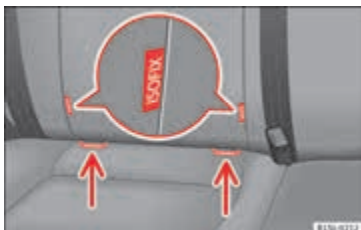
Afbeelding 21 Op de stoel van de wagen: identificatievarianten van de onderste verankeringen voor kinderzitjes.
