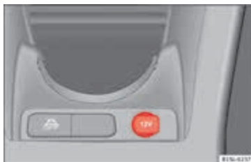
Afbeelding 68 Middenconsole voorin: 12 Volt-stopcontact in het opbergvak.
