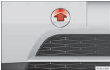
Afbeelding 135 Rechts op de voorbumper: het klepje verwijderen.
