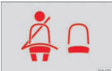
Afbeelding 6 Statusindicatie van veiligheidsgordels achterin op het display van het instrumentenpaneel.
