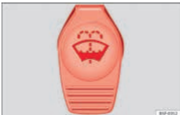
Afbeelding 112 In de motorruimte: dop van het ruitensproeiervloeistofreservoir.
