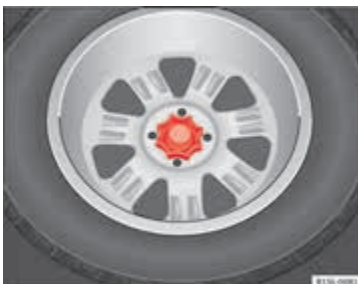
Afbeelding 118 In de bagageruimte: kartelwiel om het reservewiel vast te zetten.
