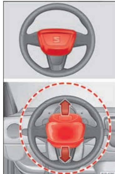
Afbeelding 12 Plaats en ontplooiingsgebied van de voorairbag van de bestuurder.
