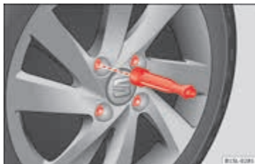
Afbeelding 131 Wiel verwisselen: de wielbouten met de schroevendraaiergreep losdraaien.
