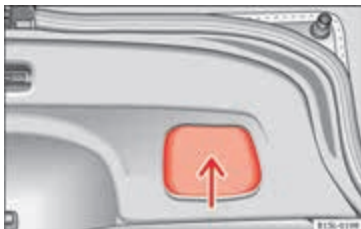
Afbeelding 38 Achterklep geopend: uitsparing voor dichttrekken.
