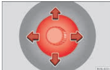
Afbeelding 51 Op de voorportieren: knop voor het verstellen van de mechanische buitenspiegel.
