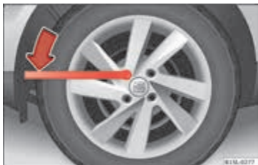
Afbeelding 127 Wiel verwisselen: de wielbouten losdraaien.
