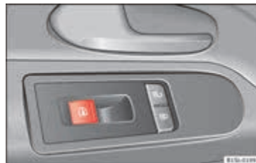
Afbeelding 39 In het bestuurdersportier: Knop voor ruitbediening.
