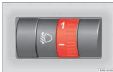
Afbeelding 45 Naast het stuur: Lichtbundelhoogteverstelling.
