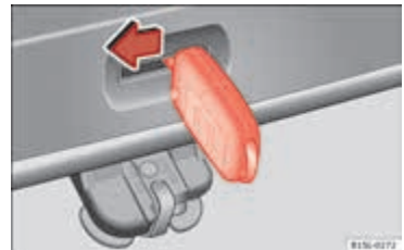
Afbeelding 140 Via de bagageruimte: noodontgrendeling van de achterklep.
