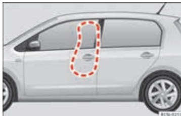
Afbeelding 15 Aan de linkerkant van de wagen: ontplooiingsgebied van de zijairbag.
