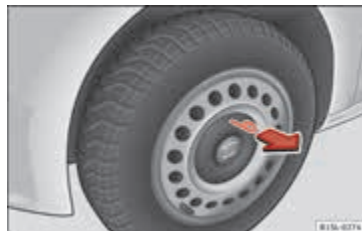
Afbeelding 124 Verwijder de wieldop van de stalen velg.
