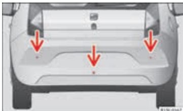
Afbeelding 85 Parkeerhulpsensoren in de achterbumper.
