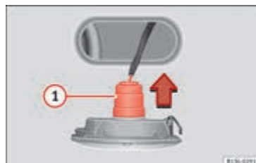
Afbeelding 154 Zijknipperlicht: lampen vervangen.
