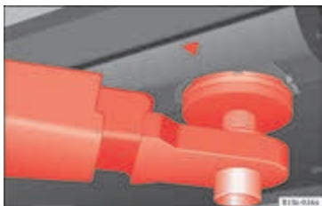
Afbeelding 96 Voorste steunpunten om de wagen met een hefbrug of krik omhoog te brengen.
