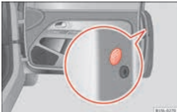
Afbeelding 138 Vooraan in het voorpassagiersportier: noodslot, verborgen door een rubberen pakking.
