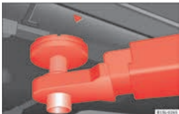
Afbeelding 97 Achterste steunpunten om de wagen met een hefbrug of krik omhoog te brengen.
