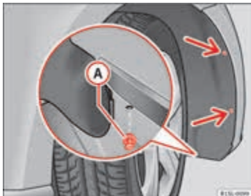
Afbeelding 147 Op het binnenscherm rechtsvoor: verwijder de bevestigingsschroef (pijlen) en verwijder de spreidklinknagel A .
