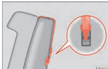
Afbeelding 22 Voorbeeld van een aangekoppelde bovenbevestigingsriem.
