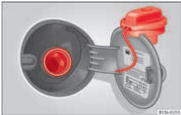
Afbeelding 103 Geopende tankklep met vastgehaakte tankdop.
