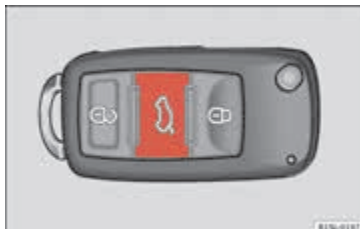
Afbeelding 37 Op de autosleutel: knop om achterklep te ontgrendelen en te openen.
