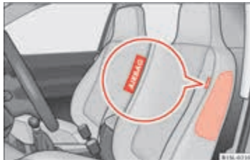
Afbeelding 14 Aan de zijkant van de voorstoel: plaats van de zijairbag.
