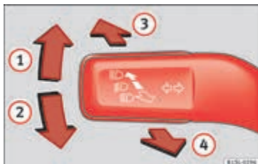
Afbeelding 44 Knipperlicht- en grootlichthendel in de basisstand.
