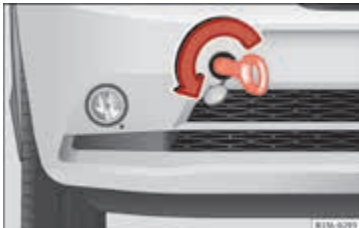
Afbeelding 136 Rechts op de voorbumper: schroef het sleepoog vast.
