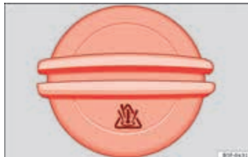
Afbeelding 110 In de motorruimte: vuldop van het koelvloeistofexpansiereservoir.
