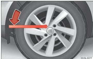
Afbeelding 53 Wiel verwisselen: de wielbouten losdraaien.
