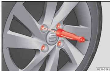
Afbeelding 57 Wiel verwisselen: de wielbouten met de schroevendraaiergreep losdraaien.
