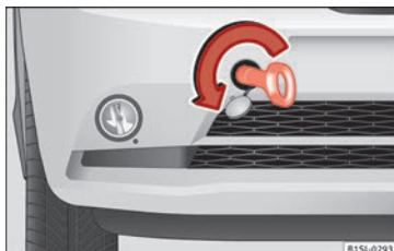
Afbeelding 81 Rechts op de voorbumper: schroef het sleepoog vast.
