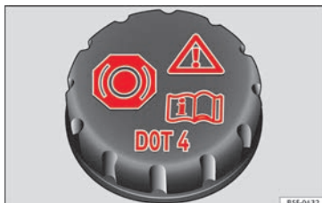
Afb. 43 Motorruimte: dop van het remvloeistofreservoir.
