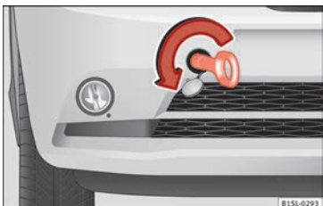
Afb. 58 Voorbumper rechts: vastgeschroefd sleepoog.
