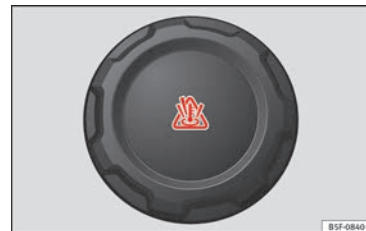
Afb. 42 Motorruimte: vuldop van het koelvloeistofexpansiereservoir.
