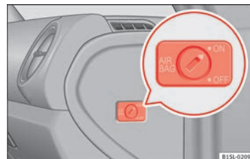
Afb. 20 Aan de voorpassagierszijde: sleutel-schakelaar om de voorairbag aan bijrijderszijde in en uit te schakelen.
