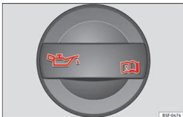
Afb. 41 In de motorruimte: dop van de motorolie-vulopening.
