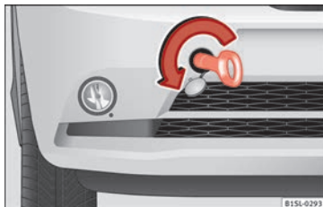
Afb. 81 Rechts op de voorbumper: schroef het sleepoog vast.
