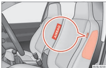
Afb. 21 Aan de zijkant van de voorstoel: plaats van de zijairbag.
