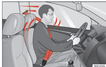
Afb. 69 Bestuurders die de veiligheidsgordel correct dragen zullen niet weggeslingerd worden bij plotseling remmen.
