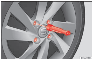
Afb. 57 Wiel verwisselen: de wielbouten met de schroevendraaiergreep losdraaien.
