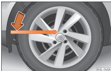
Afb. 54 Wiel verwisselen: wielbouten losdraaien.
