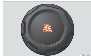
Afb. 43 Motorruimte: vuldop van het koelvloeistofexpansiereservoir.
