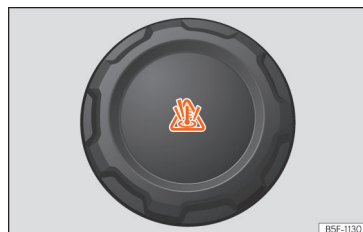
Afb. 224 Motorruimte: vuldop van het koelvloeistofexpansiereservoir.
