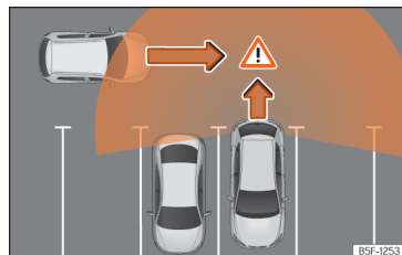
Afb. 192 Schematische weergave van de uitparkeerhelp: bewaakte zone rond de wagen die aan het uitparkeren is.
