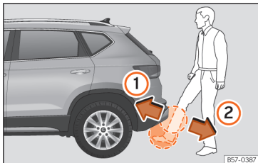
Afb. 100 Achterklep sensorgestuurd openen (Easy Open).
