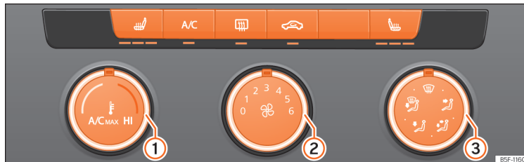
Afb. 146 In de middenconsole: Knoppen voor de handbediende airconditioning.
