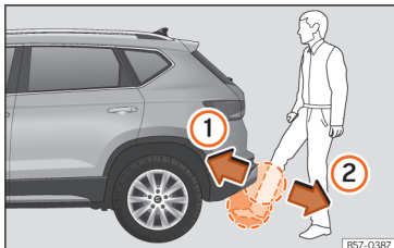
Afb. 89 Achterklep sensorgestuurd openen (Easy Open).
