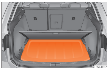
Afb. 118 In de bagageruimte: plaatsing van de plank.
