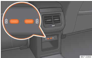
Afb. 147 Achterzijde middenconsole: USB-aansluitingen met functie van stroomvoorziening.
