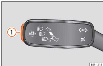
Afb. 65 In de knipperlicht- en grootlichten- del: toets voor de bestuurdershulpsystemen (naargelang het model).
