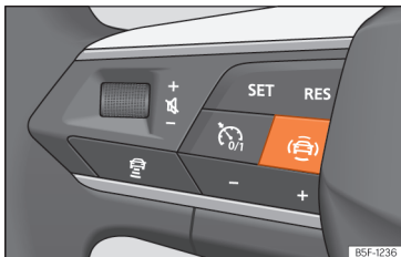
Afb. 66 Linkerzijde van het multifunctiestuur- wiel: toets voor de bestuurdershulpsystemen (naargelang het model).
