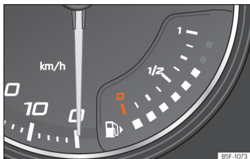
Afb. 59 Analoog instrumentenpaneel: brandstofmeter
