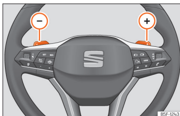
Afb. 154 Stuurwiel: hendels voor automatisch schakelen.
