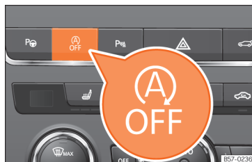
Afb. 150 Middenconsole: toets van het start-stopsysteem.
