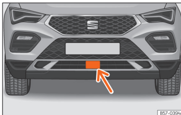
Afb. 157 In de voorbumper: radarsensor.
