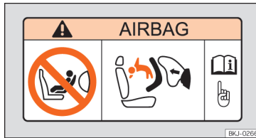
Afb. 24 Sticker van de airbag: op de zonneklep aan bestuurderszijde
