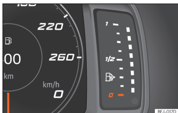
Afb. 60 Digitaal instrumentenpaneel: brandstofmeter.
