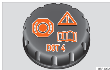
Afb. 216 Motorruimte: dop van het remvloeistofreservoir.
