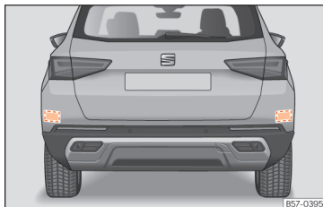
Afb. 160 Achteraanzicht van de wagen: zones van de radarsensor.
