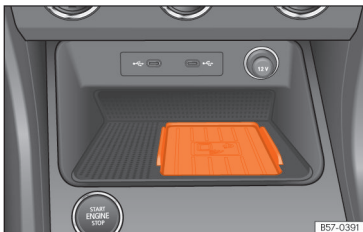
Afb. 145 In de middenconsole: steun voor het aansluiten van de mobiele telefoon.
