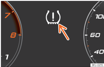
Afb. 221 Instrumentenpaneel: waarschuwing bandenspanningverlies.
