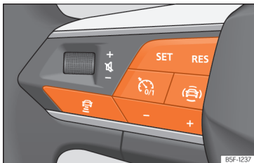
Afb. 168 Op het multifunctiestuurwiel: knoppen voor bediening van ACC
