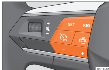
Afb. 163 Op het multifunctiestuurwiel: knoppen voor bediening van het snelheidsregelsysteem
