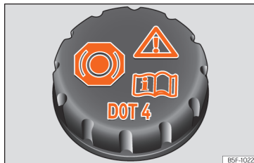
Afb. 207 Motorruimte: dop van het remvloeistofreservoir.
