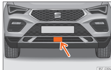
Afb. 108 In de voorbumper: radarsensor.
