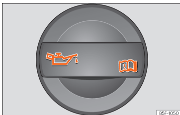
Afb. 212 In de motorruimte: dop van de motorolie-vulopening.
