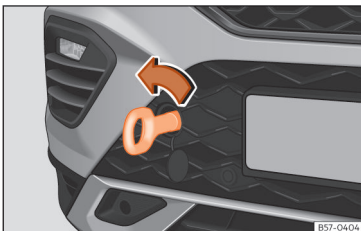
Afb. 194 Voorbumper rechts: ingeschroefd sleepoog.
