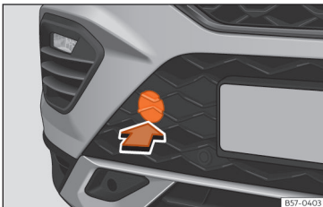
Afb. 193 Aan de rechterzijde van de voorbumper: de afdekking verwijderen.
