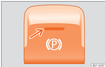
Afb. 131 Onder in de middenconsole: toets van de elektronische parkeerrem.
