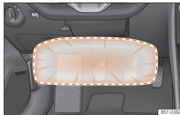
Afb. 35 Aan de bestuurderszijde: werkingsgebied van de airbag voor de knieën.
