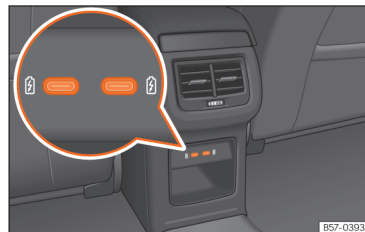
Afb. 157 Achterzijde middenconsole: USB-aansluitingen met functie van stroomvoorziening.
