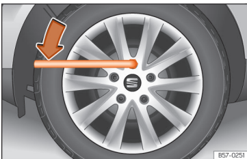
Afb. 222 Wiel verwisselen: wielbouten losdraaien.
