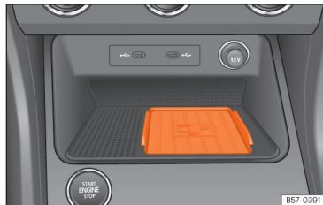
Afb. 164 In de middenconsole: steun voor het aansluiten van de mobiele telefoon.
