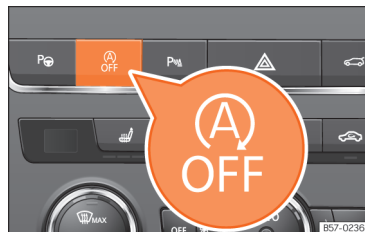
Afb. 99 Middenconsole: toets van het start-stopsysteem.
