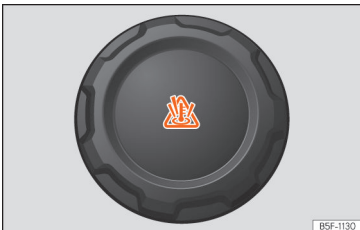
Afb. 206 Voorruimte: vuldop van het koelvloeistofexpansiereservoir.
