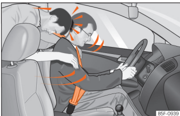
Afb. 22 De niet-vastgegespte passagier op een zitplaats achterin vliegt naar voren op de vastgegespte bestuurder.
