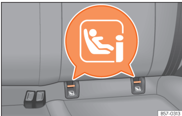
Afb. 39 Achterstoel: locatie van de ISOFIX- of i-Size-bevestigingsbeugels.
