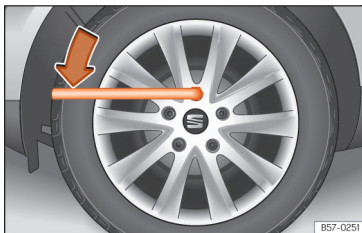
Afb. 219 Wiel verwisselen: wielbouten losdraaien.
