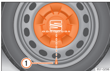
Afb. 216 Juiste plaatsing van de centrale wioldop voor stalen velgen.
