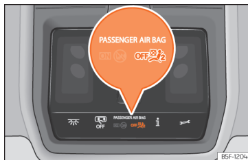
Afb. 21 In de dakconsole: controlelampje voor buiten werking gestelde bijrijdersairbag.
