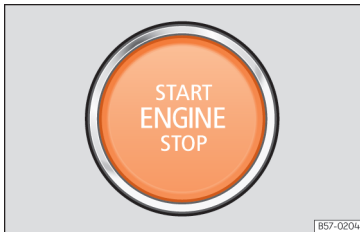
Afb. 161 Onder in de middenconsole: startknop
