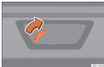
Afb. 97 Detail van de bagageruimte: noodontgrendeling (Leon Sportstourer).
