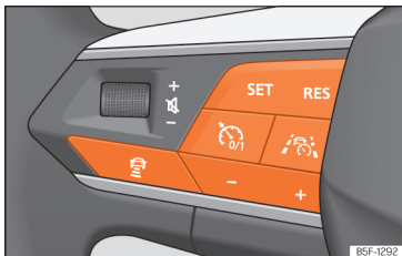
Afb. 187 Linkerzijde van het multifunctiestuurwiel: toetsen voor bediening van Travel Assist.
