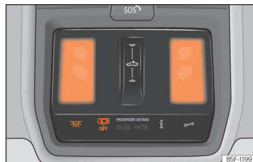
Afb. 104 Deel van de hemelbekleding: binnenverlichting voorin.
