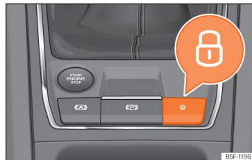
Afb. 86 In middenconsole: schakelaar van de centrale vergrendeling
