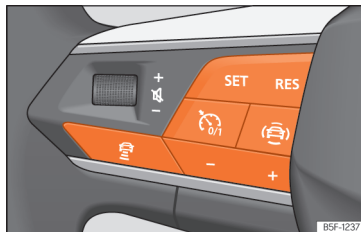
Afb. 179 Op het multifunctiestuurwiel: knoppen voor bediening van ACC
