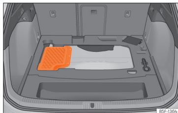
Afb. 231 Inbouwplaats van de accu in de bagageruimte
