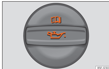
Afb. 225 In de motorruimte: dop van de motorolie-vulopening.
