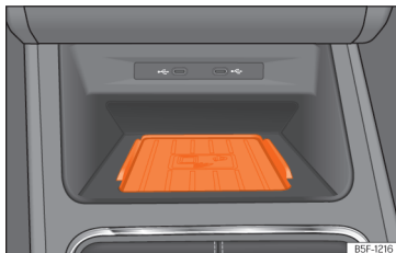
Afb. 158 In de middenconsole: steun voor het aansluiten van de mobiele telefoon.
