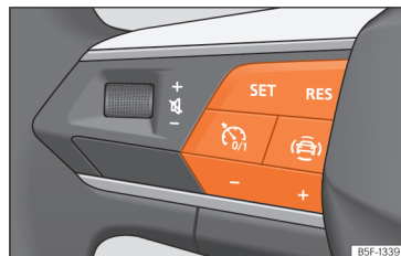
Afb. 174 Op het multifunctiestuurwiel: knoppen voor bediening van de snelheidsbegrenzer
