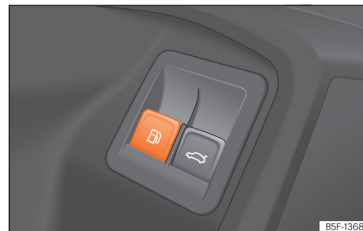
Afb. 217 Bestuurdersportier: ontgrendeling van de tankklep.
