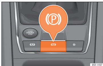
Afb. 195 Onder in de middenconsole: toets van de elektronische parkeerrem.
