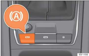
Afb. 196 Onder in de middenconsole: toets van de Auto Hold-functie.
