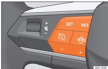
Afb. 173 Op het multifunctiestuurwiel: knoppen voor bediening van het snelheidsregelsysteem
