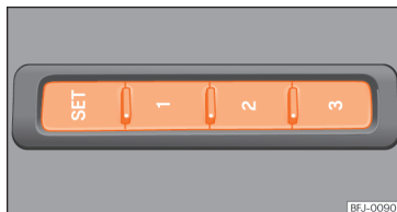
Afb. 116 Aan de buitenzijde van de bestuurdersstoel: geheugentoetsen.
