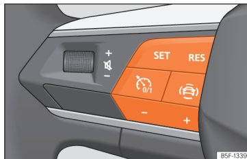
Afb. 177 Op het multifunctiestuurwiel: knoppen voor bediening van het snelheidsregelsysteem
