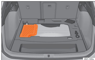
Afb. 239 Hybride wagens [PHEV]: locatie van de accu in de bagageruimte
