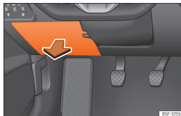
Afb. 56 In het dashboard aan bestuurderszijde: afdekking van de zekeringenhouder.
