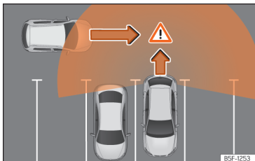
Afb. 195 Schematische weergave van de uitparkeerhulp: bewaakte zone rond de wagen die aan het uitparkeren is.
