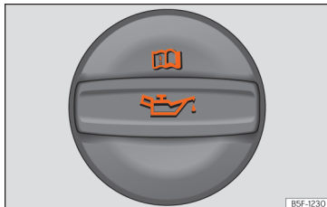
Afb. 233 In de motorruimte: dop van de motorolie-vulopening.
