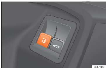
Afb. 222 Bestuurdersportier: ontgrendeling van de tankklep.
