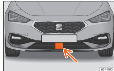
Afb. 171 In de voorbumper: radarsensor.
