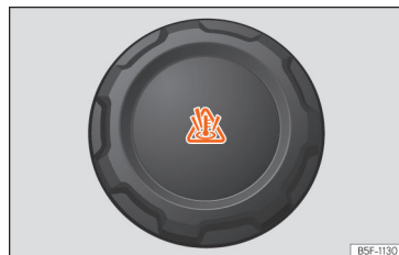
Afb. 236 Motorruimte: vuldop van het koelvloeistofexpansiereservoir.
