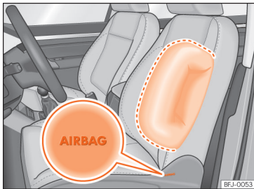
Afb. 26 Zij-airbag in de bestuurdersstoel.
