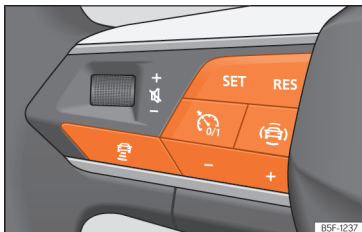
Afb. 182 Op het multifunctiestuurwiel: knop voor bediening van ACC
