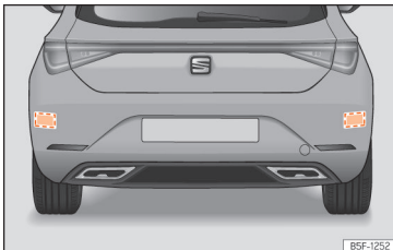
Afb. 174 Achteraanzicht van de wagen: zones van de radarsensor.
