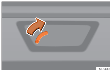
Afb. 98 Detail van de bagageruimte: noodontgrendeling (Leon Sportstouder).
