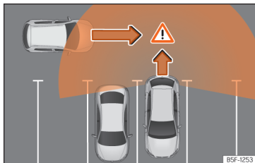
Afb. 193 Schematische weergave van de uitparkeerhulp: bewaakte zone rond de wagen die aan het uitparkeren is.
