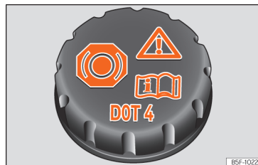
Afb. 235 Motorruimte: dop van het remvloeistofreservoir.
