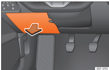
Afb. 55 In het dashboard aan bestuurderszijde: afdekking van de zekeringenhouder.
