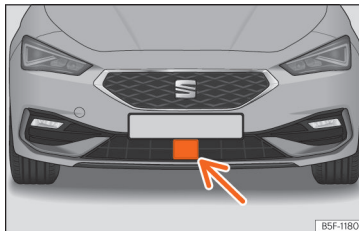
Afb. 169 In de voorbumper: radarsensor.
