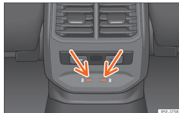
Afb. 162 Achterzijde middenconsole: USB-aansluitingen met functie van stroomvoorziening.
