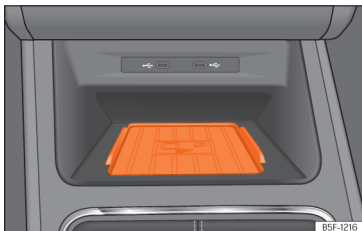
Afb. 160 In de middenconsole: steun voor het aansluiten van de mobiele telefoon.
