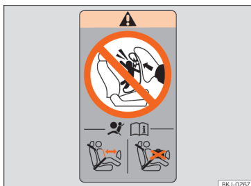
Afb. 31 Sticker van de airbag: in de achterste omlijsting van het bijrijdersportier
