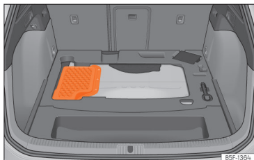
Afb. 237 Hybride wagens (PHEV): locatie van de accu in de bagageruimte
