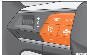
Afb. 176 Op het multifunctiestuurwiel: knoppen voor bediening van de snelheidsbegrenzer
