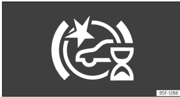
Afb. 178 Op het display van het instrumentenpaneel: aanwijzing van initiële zelfkalibratie van het systeem.
