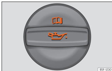
Afb. 231 In de motorruimte: dop van de motorolie-vulopening.
