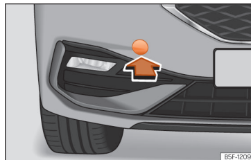
Afb. 51 Aan de rechterzijde van de voorbumper: de afdekking verwijderen.
