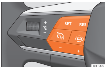
Afb. 175 Op het multifunctiestuurwiel: knoppen voor bediening van het snelheidsregelsysteem
