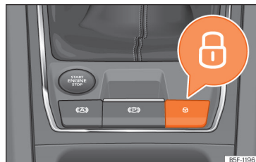
Afb. 87 In middenconsole: schakelaar van de centrale vergrendeling
