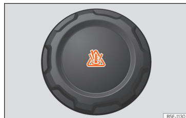
Afb. 234 Motorruimte: vuldop van het koelvloeistofexpansiereservoir.
