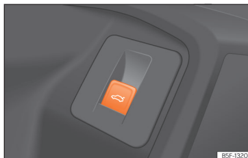
Afb. 95 In het bestuurdersportier: toets om de achterklep te openen en sluiten.
