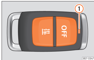
Afb. 153 Interieurverwarming: radiografische afstandsbediening.
