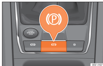
Afb. 196 Onder in de middenconsole: toets van de elektronische parkeerrem.
