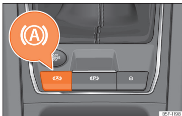
Afb. 197 Onder in de middenconsole: toets van de Auto Hold-functie.
