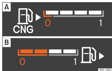
Afb. 69 Digitaal instrumentenpaneel: A : Aardgasmeter. B : Benzinemeter
