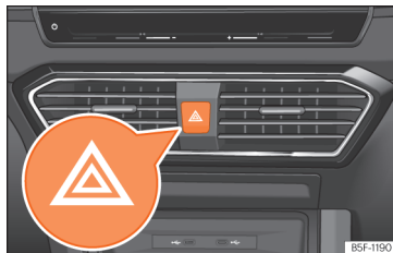
Afb. 52 Dashboard: schakelaar voor alarmlichten.
