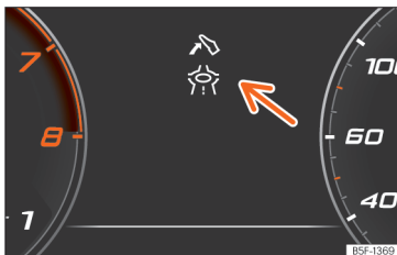
Afb. 14 Aanwijzing van het hulpsysteem voor eco-efficiënt rijden (schematische voorstelling).
