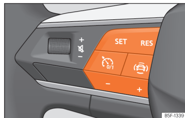
Afb. 129 Op het multifunctiestuurwiel: knoppen voor bediening van het snelheidsregelsysteem.
