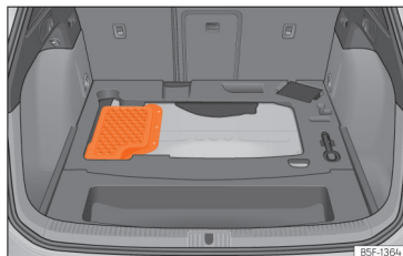
Afb. 230 Hybride wagens (PHEV): locatie van de accu in de bagageruimte
