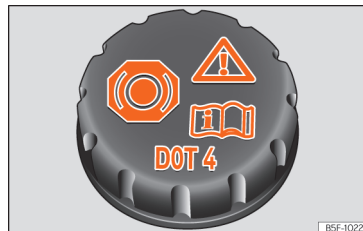
Afb. 224 Motorruimte: dop van het remvloeistofreservoir.
