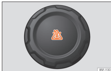
Afb. 223 Voorruimte: vuldop van het koelvloeistofexpansiereservoir.
