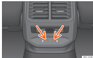
Afb. 166 Achterzijde middenconsole: USB-aansluitingen met functie van stroomvoorziening.
