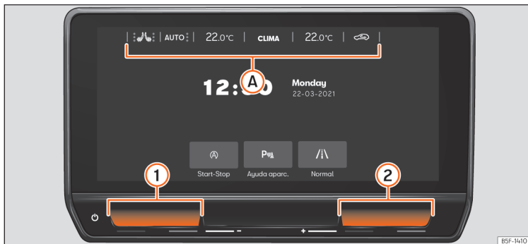
Afb. 111 Schematische voorstelling: functies van de klimatisering.
