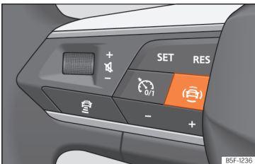
Afb. 122 Linkerzijde van het multifunctiestuurwiel: toets voor de bestuurdershulpsystemen (naargelang het model).
