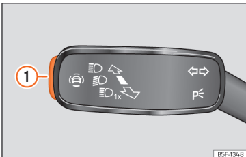
Afb. 121 Knipperlicht- en grootlichthendel: toets voor de bestuurdershulpsystemen (naargelang het model).
