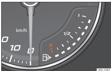
Afb. 6 Analooq instrumentenpaneel: brandstofmeter.
