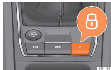
Afb. 74 In de middenconsole: schakelaar van de centrale vergrendeling
