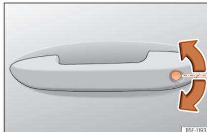
Fig. 76 Driver door handle: locking cylinder.
