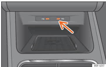
Fig. 165 Centre console: USB input.
