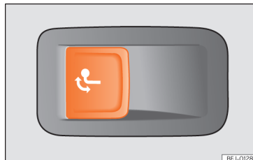
Afb. 297 Aan de linkerzijde van de bagage-ruimte: toets voor het ontgrendelen van de kogelkop.
