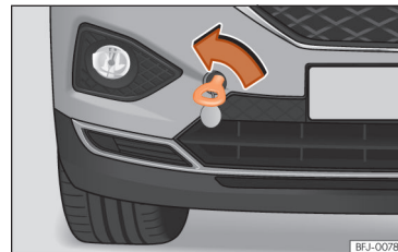
Afb. 79 Voorbumper rechts: ingeschroefd sleepoog.
