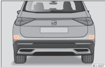
Afb. 274 Achteraanzicht van de wagen: zones van de radarsensoren.
