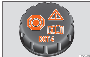
Afb. 63 Motorruimte: dop van het remvloeistofreservoir.
