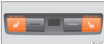
Afb. 189 Achteraan in de middenconsole: bedieningsknoppen voor verwarming van de achterstoelen.
