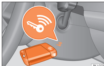
Afb. 244 Rechts van de stuurkolom: noodstart.
