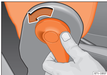
Afb. 149 Inklapbare rugleuning van de bijrijdersstoel ontgrendelen.
