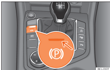
Afb. 246 Onder in de middenconsole: toets van de elektronische parkeerrem.
