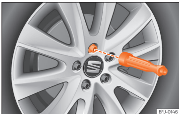
Afb. 78 Wiel: de wielbouten met de schroevendraaiergreep losdraaien.
