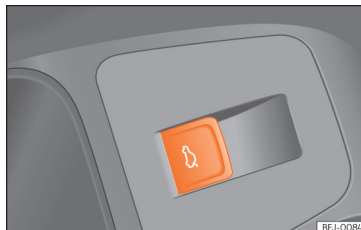
Afb. 126 In het bestuurdersportier: knop om de achterklep te openen en sluiten.
