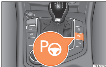
Afb. 279 Boven in de middenconsole: toets om het inparkeersysteem in te schakelen.
