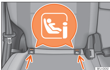
Afb. 37 Stoelen aan de zijkanten van de tweede zitrij: ISOFIX/Size-bevestigingsbeugels.
