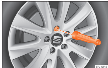
Afb. 42 Wiel verwisselen: de wielbouten met de schroevendraaiergreep losdraaien.
