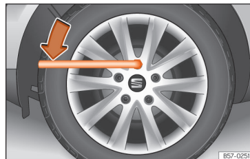
Afb. 38 Wiel verwisselen: wielbouten losdraaien.
