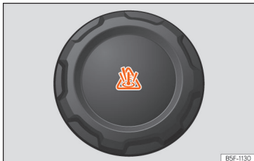
Afb. 316 Motorruimte: vuldop van het koelvloeistofexpansiereservoir.
