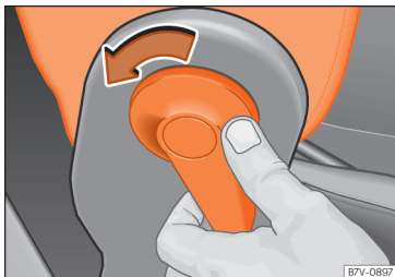
Afb. 113 Inklapbare rugleuning van de bijrijdersstoel ontgrendelen.
