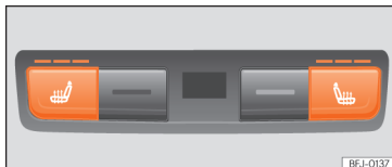
Afb. 150 Achter in de middenconsole: schakelaars voor stoelverwarming voor de achterstoelen.
