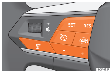
Afb. 185 Op het multifunctiestuurwiel: knoppen voor bediening van ACC
