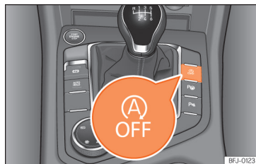
Afb. 163 Middenconsole: toets van het start-stopsysteem.
