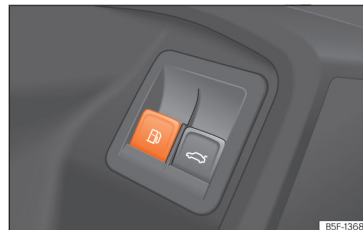
Afb. 234 Bestuurdersportier: ontgrendeling van de tankklep.
