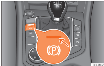
Afb. 199 Onder in de middenconsole: toets van de elektronische parkeerrem.
