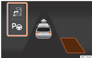
Afb. 202 Op het display van het instrumentenpaneel: beperkte weergave van het inparkeersysteem.
