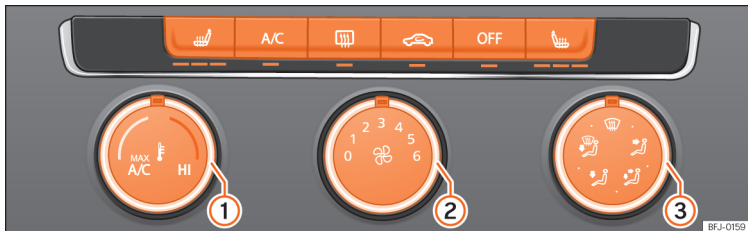
Afb. 147 In de middenconsole: knoppen voor de handbediende airconditioning.
