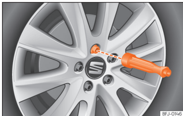
Afb. 39 Wiel verwisselen: de wielbouten met de schroevendraaiergreep losdraaien.
