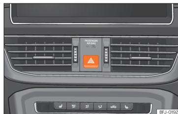
Afb. 95 Dashboard: schakelaar voor alarmlichten.
