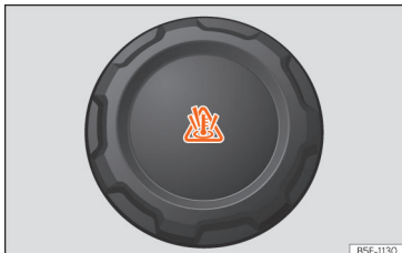
Afb. 245 Motorruimte: vuldop van het koelvloeistofexpansiereservoir.
