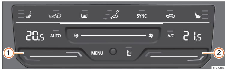
Afb. 146 In de middenconsole: bedieningselementen van de Climatronic.
