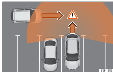
Afb. 198 Schematische weergave van de uitparkeerhelp: bewaakte zone rond de wagen die aan het uitparkeren is.
