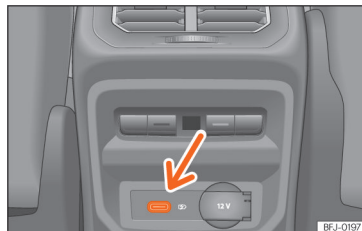
Afb. 160 Achterzijde middenconsole: USB-aansluitingen met functie van stroomvoorziening.
