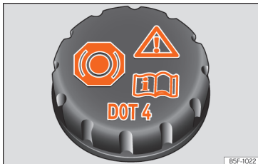
Afb. 246 Motorruimte: dop van het remvloeistofreservoir.
