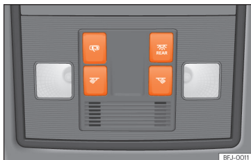
Afb. 97 Deel van de hemelbekleding: binnenverlichting voorin.
