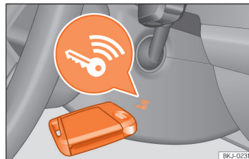
Afb. 163 Rechts van de stuurkolom: noodstart.
