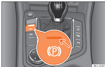
Afb. 198 Onder in de middenconsole: toets van de elektronische parkeerrem.
