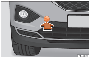
Afb. 45 Aan de rechterzijde van de voorbumper: de afdekking verwijderen.
