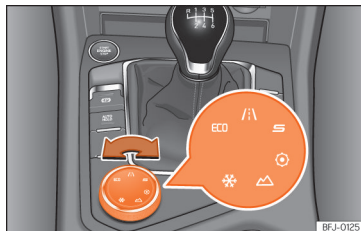
Afb. 171 Middenconsole: draaiknop (Driving Experience button).
