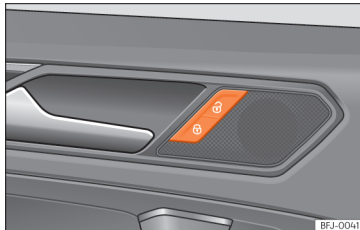
Afb. 77 Bestuurdersportier: schakelaar van de centrale vergrendeling.
