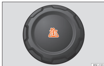
Afb. 246 Motorruimte: vuldop van het koelvloeistofexpansiereservoir.
