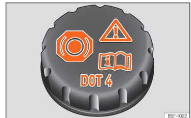
Afb. 237 Motorruimte: dop van het remvloeistofreservoir.
