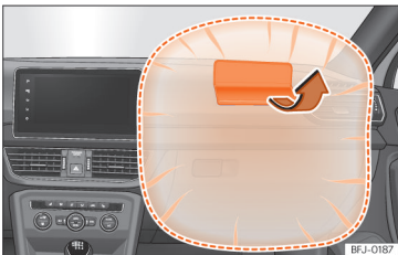
Afb. 31 Bijrijdersairbag in het dashboard.
