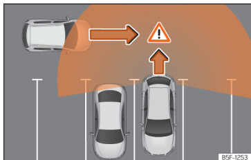
Afb. 174 Schematische voorstelling van de uitparkeerhulp: bewaakt gebied rond de wagen die een parkeerplaats verlaat
