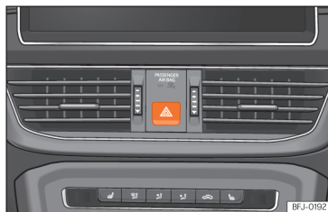
Afb. 49 Dashboard: schakelaar voor alarmlichten.
