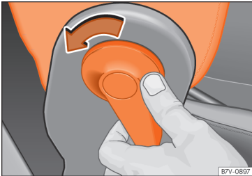
Afb. 90 Inklapbare rugleuning van de bijrijdersstoel ontgrendelen.
