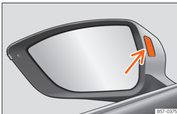
Afb. 150 Controlelampje van de rijstrookwisselassistent.
