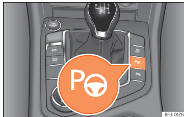
Afb. 161 In de middenconsole: toets om het inparkeersysteem in te schakelen.
