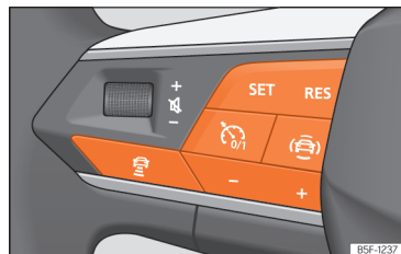
Afb. 140 Op het multifunctiestuurwiel: knoppen voor bediening van ACC.
