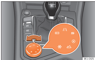
Afb. 127 Middenconsole: draaiknop (Driving Experience button).
