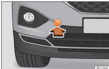
Afb. 224 Aan de rechterzijde van de voorbumper: de afdekking verwijderen.
