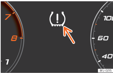
Afb. 257 Instrumentenpaneel: waarschuwing bandenspanningverlies.
