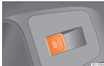
Afb. 77 In het bestuurdersportier: knop om de achterklep te openen en sluiten.
