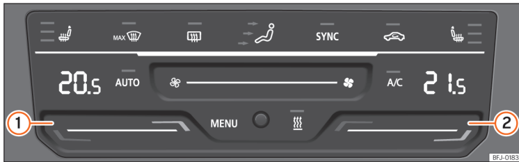
Afb. 112 In de middenconsole: bedieningselementen van Climatronic.
