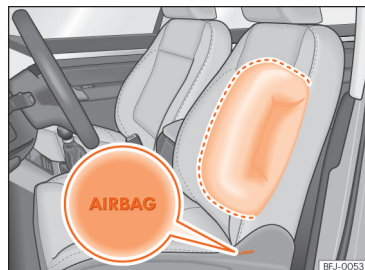
Afb. 34 Zij-airbag in de bestuurdersstoel.
