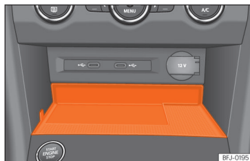
Afb. 192 In de middenconsole: steun voor het aansluiten van de mobiele telefoon.
