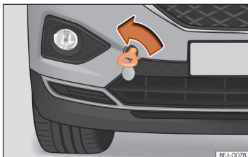
Afb. 225 Voorbumper rechts: ingeschroefd sleepoog.
