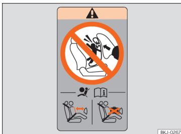
Afb. 40 Airbagsticker: in de achterste omlijsting van het bijrijdersportier.
