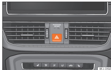
Afb. 96 Dashboard: schakelaar voor alarmlichten.
