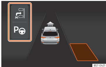
Afb. 203 Op het display van het instrumentenpaneel: beperkte weergave van het inparkeersysteem.
