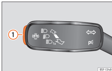
Afb. 64 In de knipperlicht- en grootlichthendel: toets voor de bestuurdershulpsystemen (naargelang het model).
