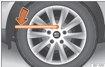
Afb. 35 Wiel verwisselen: wielbouten losdraaien.
