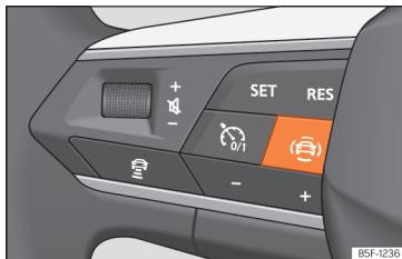
Afb. 65 Linkerzijde van het multifunctiestuurwiel: toets voor de bestuurdershulpsystemen (naargelang het model).
