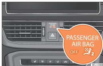
Afb. 18 Dashboard: controlelampje voor buiten werking gestelde bijrijdersairbag.
