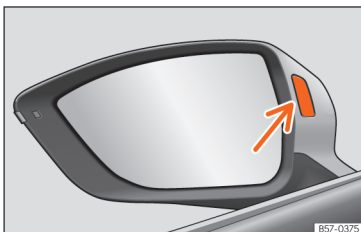
Afb. 195 Controlelampje van de rijstrookwisselhulp.
