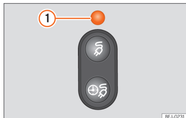
Afb. 229 Achter de acculaadklep: laadprocesindicatie.
