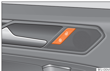
Afb. 77 Bestuurdersportier: schakelaar van de centrale vergrendeling.
