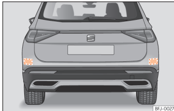
Afb. 178 Achteraanzicht van de wagen: zones van de radarsensor.
