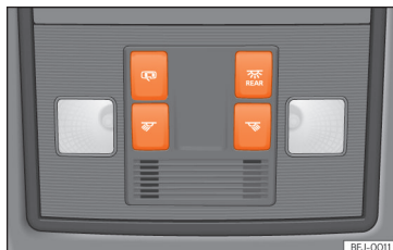
Afb. 97 Deel van de hemelbekleding: binnenverlichting voorin.
