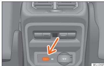
Afb. 163 Achterzijde middenconsole: USB-aansluitingen met functie van stroomvoorziening.
