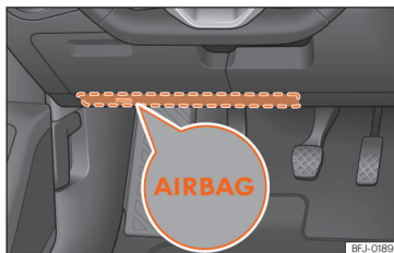
Afb. 19 Aan de bestuurderszijde: plaats van de airbag voor de knieën.
