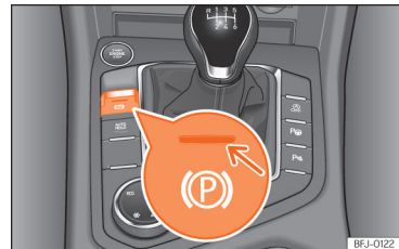
Afb. 200 Onder in de middenconsole: toets van de elektronische parkeerrem.
