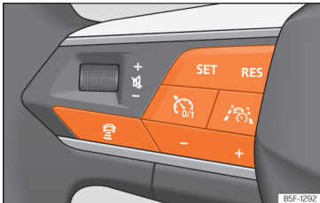
Afb. 194 Linkerzijde van het multifunctiestuurwiel: toetsen voor bediening van Travel Assist.
