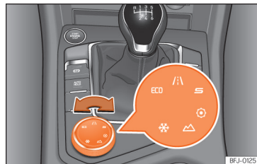
Afb. 173 Middenconsole: draaiknop (Driving Experience button).
