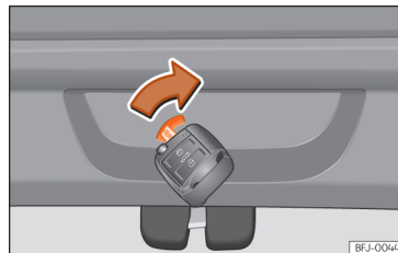
Afb. 88 Detail van de bagageruimte: noodontgrendeling.
