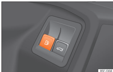
Afb. 235 Bestuurdersportier: ontgrendeling van de tankklep.
