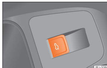
Afb. 86 In het bestuurdersportier: toets om de achterklep te openen en sluiten.
