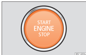
Afb. 164 Onder in de middenconsole: startknop
