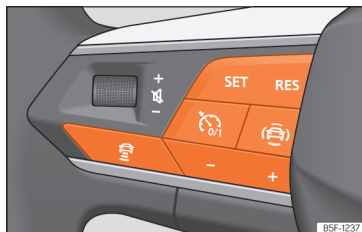
Afb. 186 Op het multifunctiestuurwiel: knoppen voor bediening van ACC
