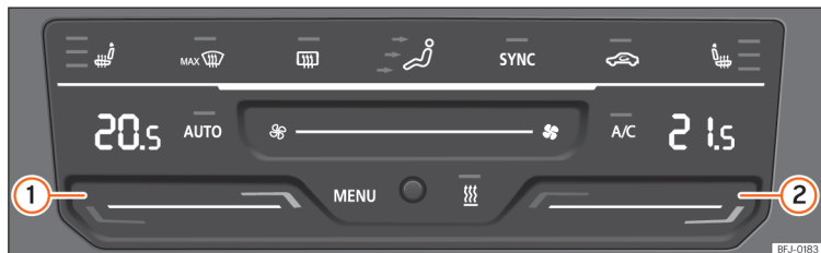
Afb. 147 In de middenconsole: bedieningselementen van de Climatronic.
