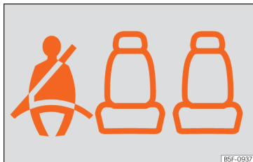
Afb. 6 Instrumentenpaneel: geeft aan dat de plaats linksachter bezet is en de overeenkomstige veiligheidsgordel juist is omgedaan.
