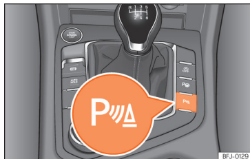
Afb. 158 Middenconsole: toets van de parkeerhulp (naargelang de versie).
