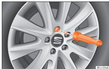
Afb. 256 Wiel verwisselen: de wielbouten met de schroevendraaiergreep losdraaien.
