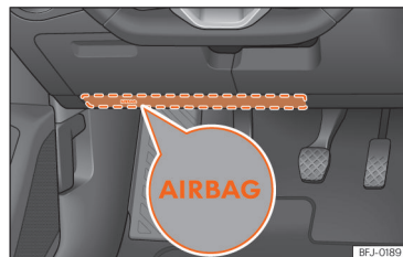
Afb. 36 Aan de bestuurderszijde: plaats van de airbag voor de knieën.
