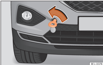
Afb. 225 Voorbumper rechts: ingeschroefd sleepoog.
