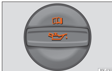
Afb. 242 In de motorruimte: dop van de motorolie-vulopening.
