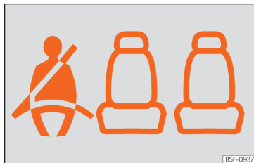
Afb. 22 Instrumentenpaneel: indicatie van de staat van de veiligheidsgordels voor de zitplaatsen achterin.
