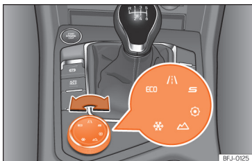
Afb. 127 Middenconsole: draaiknop (Driving Experience button).
