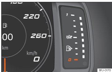
Afb. 7 Instrumentenpaneel SEAT Digital Cockpit: brandstofmeter.
