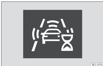
Afb. 145 In het display van het instrumentenpaneel: aanwijzing van initiële zelfkalibratie van het systeem.
