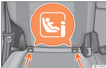
Afb. 41 Achterstoel: locatie van de ISOFIX- of i-Size-bevestigingsbeugels.
