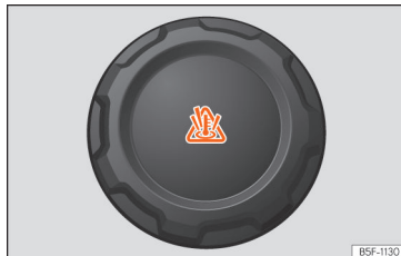
Afb. 236 Voorruimte: vuldop van het koelvloeistofexpansiereservoir.
