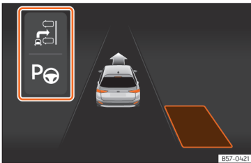
Afb. 162 Op het display van het instrumentenpaneel: beperkte weergave van het inparkeersysteem.
