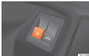
Afb. 215 Bestuurdersportier: ontgrendeling van de tankklep.
