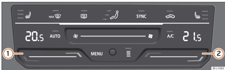
Afb. 112 In de middenconsole: bedieningselementen van Climatronic.
