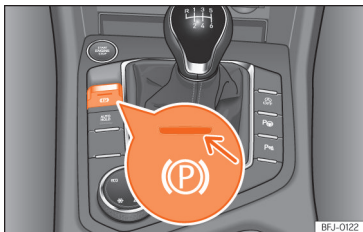
Afb. 154 Onder in de middenconsole: toets van de elektronische parkeerrem.
