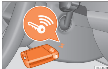
Afb. 119 Rechts van de stuurkolom: noodstart.
