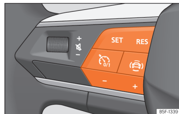
Afb. 137 Op het multifunctiestuurwiel: knoppen voor bediening van het snelheidsregelsysteem.
