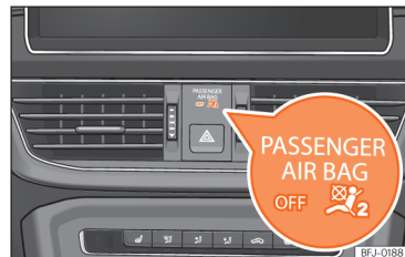
Afb. 33 Instrumentenpaneel: controlelampje van buiten werking stellen van de bijrijdersairbags.
