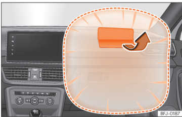
Afb. 31 Bijrijdersairbag in het dashboard.
