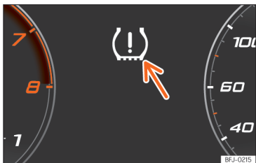
Afb. 257 Instrumentenpaneel: waarschuwing bandenspanningverlies.
