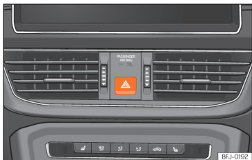
Afb. 49 Dashboard: schakelaar voor alarmlichten.
