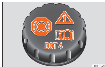
Afb. 237 Motorruimte: dop van het remvloeistofreservoir.
