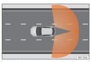
Fig. 135 Sensor detection zones.
