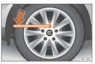
$\textbf{Fig. 252} \quad \textbf{Tyre change: slacken the wheel bolts.}$
